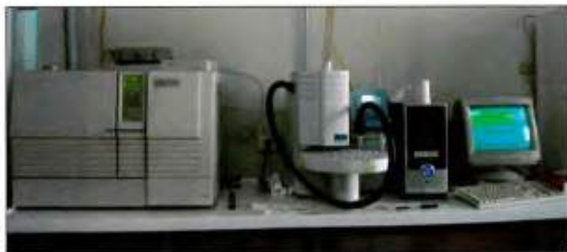
Figura 7. Cromatógrafo de gases con detección por espectrometría de masas (Shimadzu GC-MS QP 5050).
