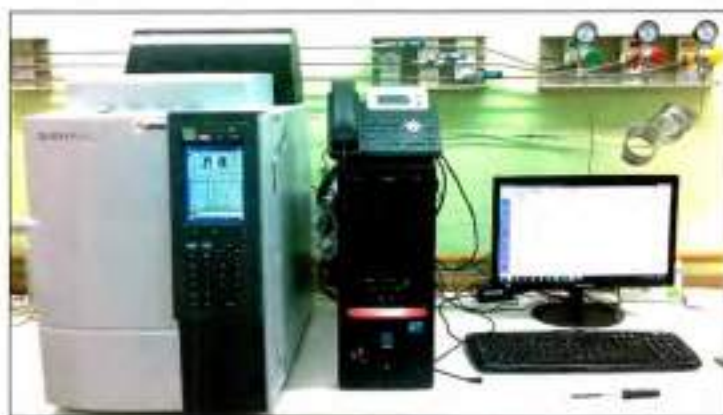
Figura 6. Cromatógrafo de gases con detección por ionización de Llama (Shimadzu GC-2014B)
