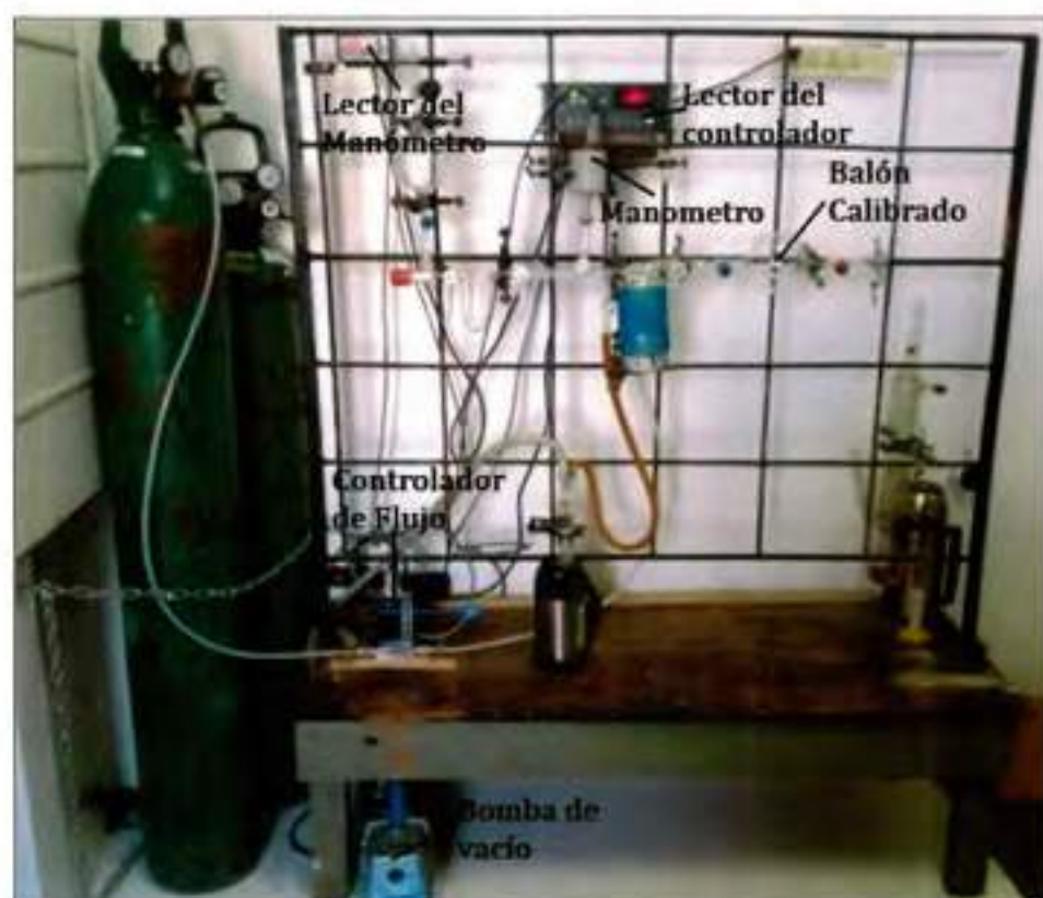
Figura 2. Sistema de vacío usado para manipulación de gases.
