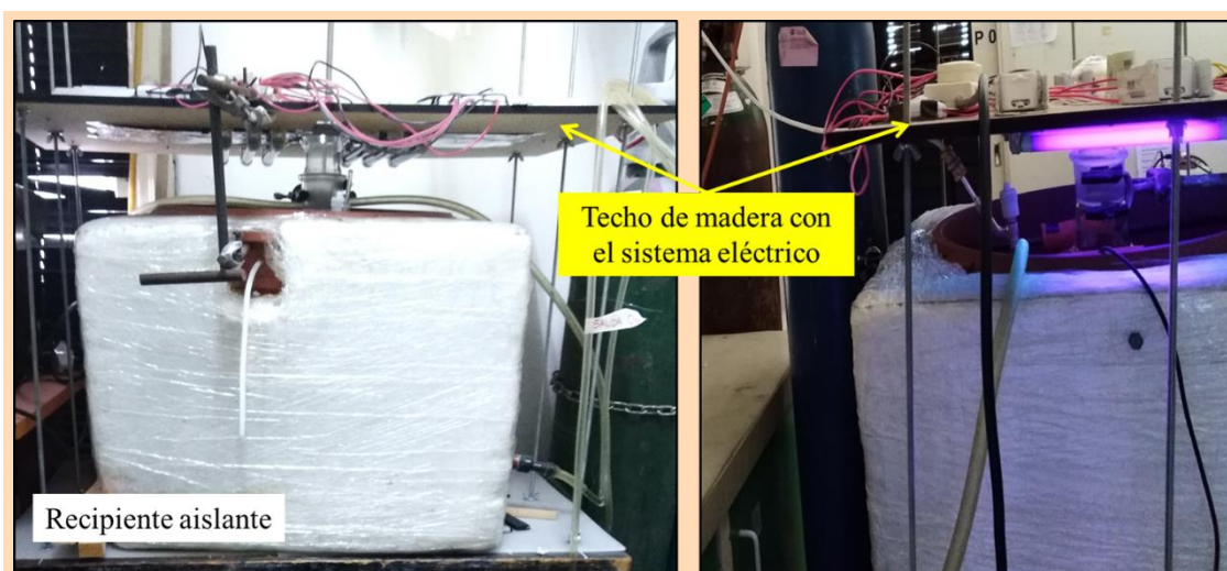
Figura 5: A la izquierda, balón de 12 L empleado en la síntesis en el interior del recipiente aislante, en la parte superior el "techo de madera" con las lámparas negras empleadas. A la derecha, sistema en funcionamiento. Se puede observar la conexión del balón al sistema de vacío mediante una manguera de teflón como se indicó en el esquema de la figura 1.
