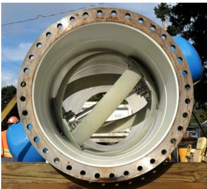
Ilustración 25: LucidPipe™. Turbina esférica.
