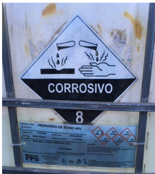
Ilustración 10: Etiquetado, señalización y clase de peligro. Visualización del material de almacenamiento.
