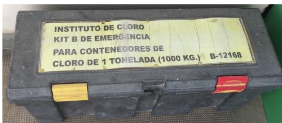
Ilustración 15: Kit de emergencia para fuga de Cloro.
