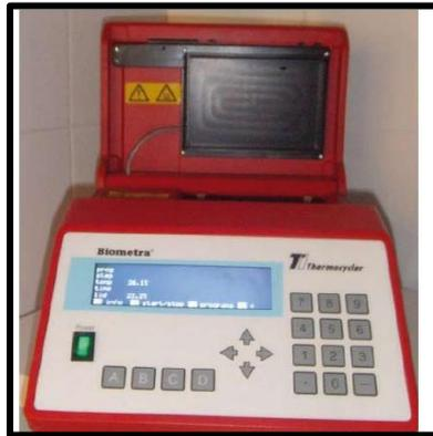
Figura 26: Termociclador para realizar PCR
