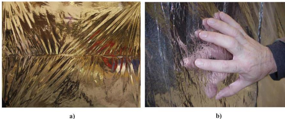
Figura 4.24 - a) Arrugas y b) Pliegues en un film típico de velas solares. Fuente: Macdonald (2014)
