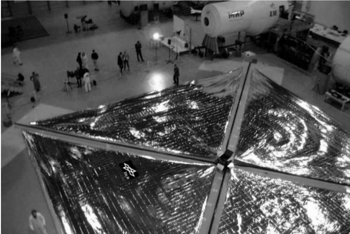
Figura 1.1 - Prueba de despliegue de una vela solar de 20m \times 20m , Diciembre 1999. Fuente: McInnes (2003)
