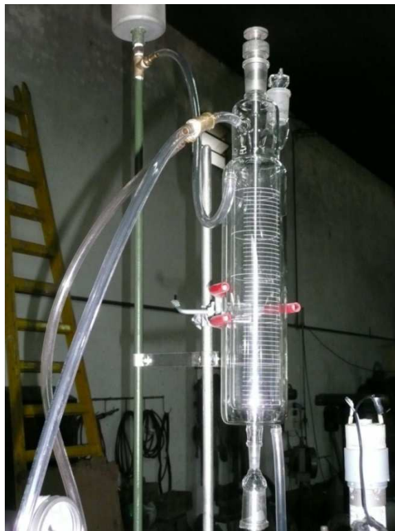
Figura 3.7: Alimentador del destilador molecular, con camisa para calefacción con agua y escala graduada.
