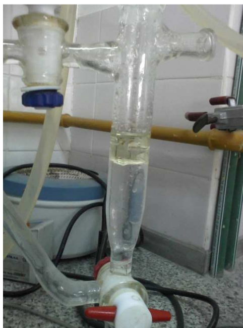
Figura 2.2: Aceite esencial de romero obtenido en equipo hidrodestilador Figmay
