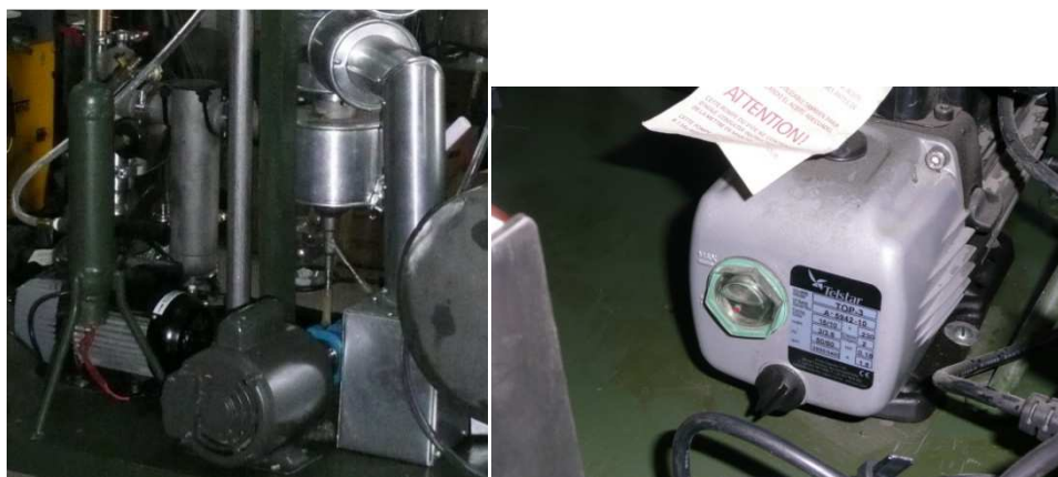
Figura 3.13: Ubicación de la bomba mecánica y de la de aceite térmico, e indicación de nivel de la bomba mecánica.
