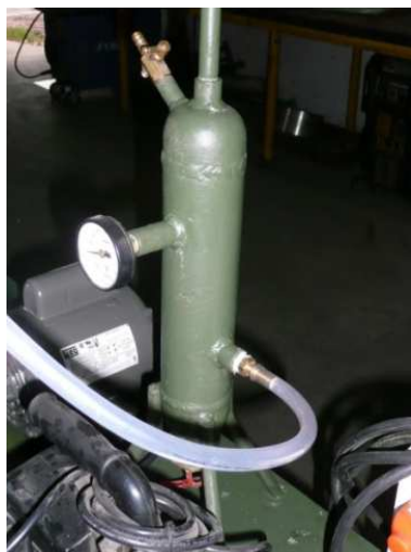
Figura 3.8: Cuerpo contenedor de resistencia eléctrica para la calefacción por termosifón.
