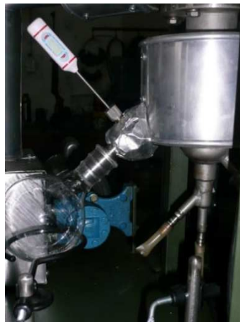
Figura 3.10: Medición de la temperatura del residuo con termorresistencia en línea.
