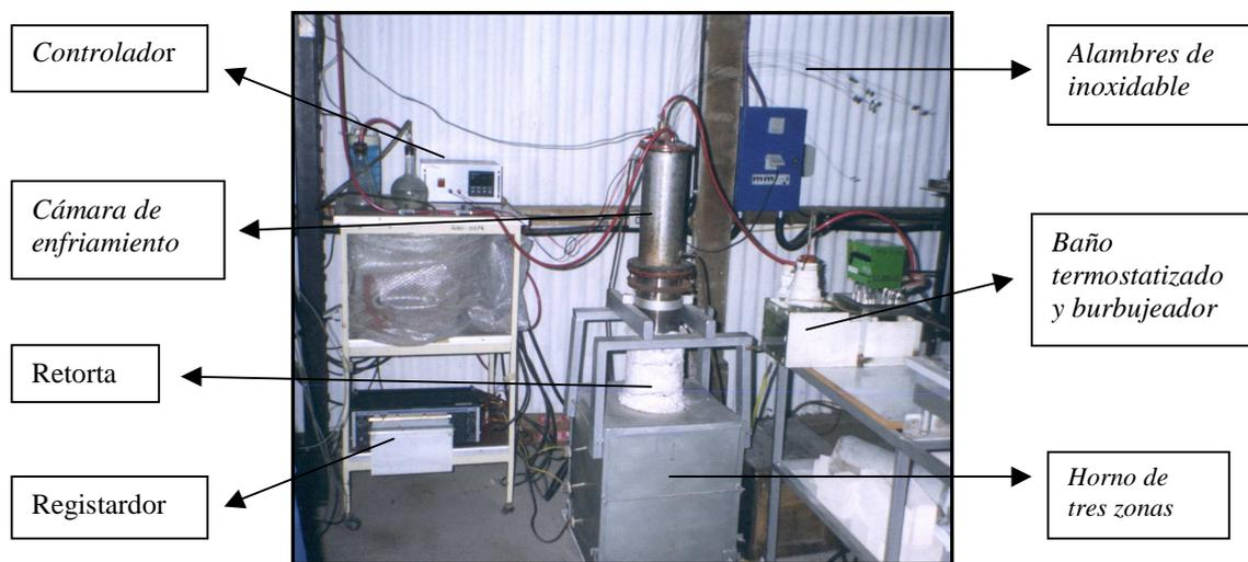
**Fotografía 3.1:** Horno de tratamiento térmico con control de atmósfera
