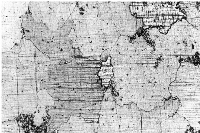
**Micrografía 5.2:** Microestructura de la muestra M luego de un tratamiento isotérmico de 2 horas a 750 °C. X 50
