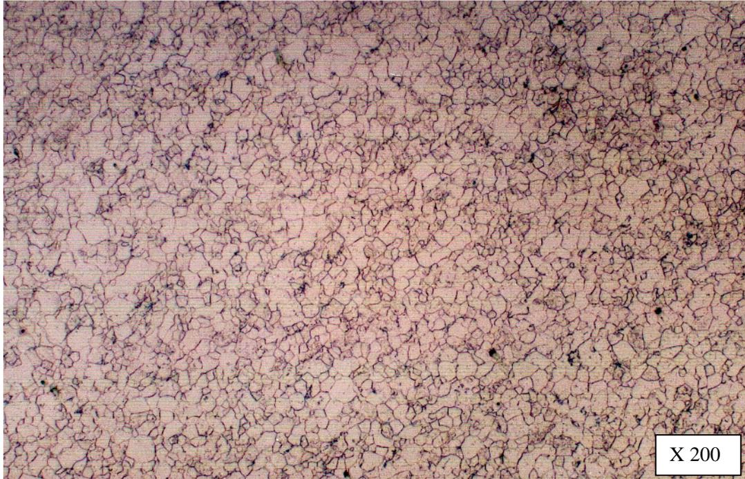
**Micrografía 6.7:** Microestructura de la muestra A en el estado AR
