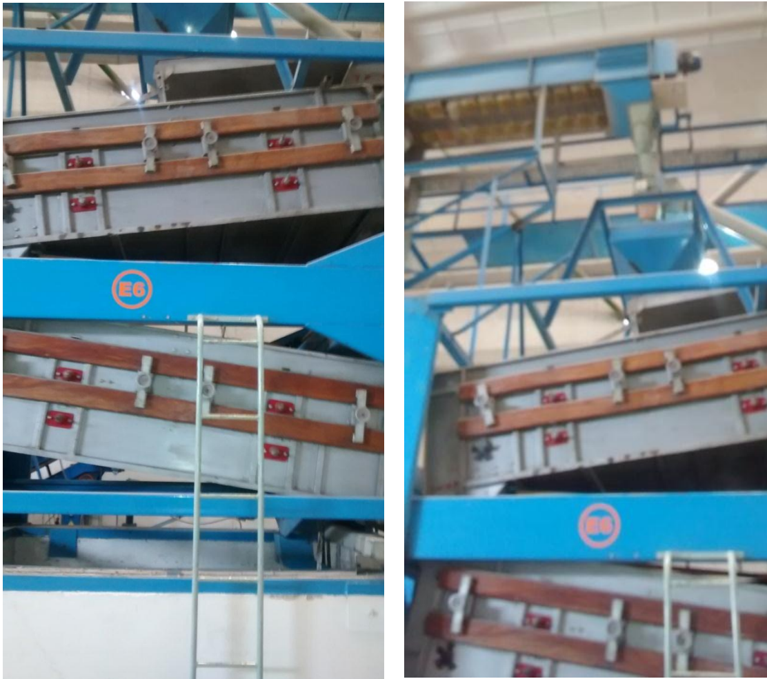
Figura 15 y 16: Calibradora: Seleccionadora por tamaño.
