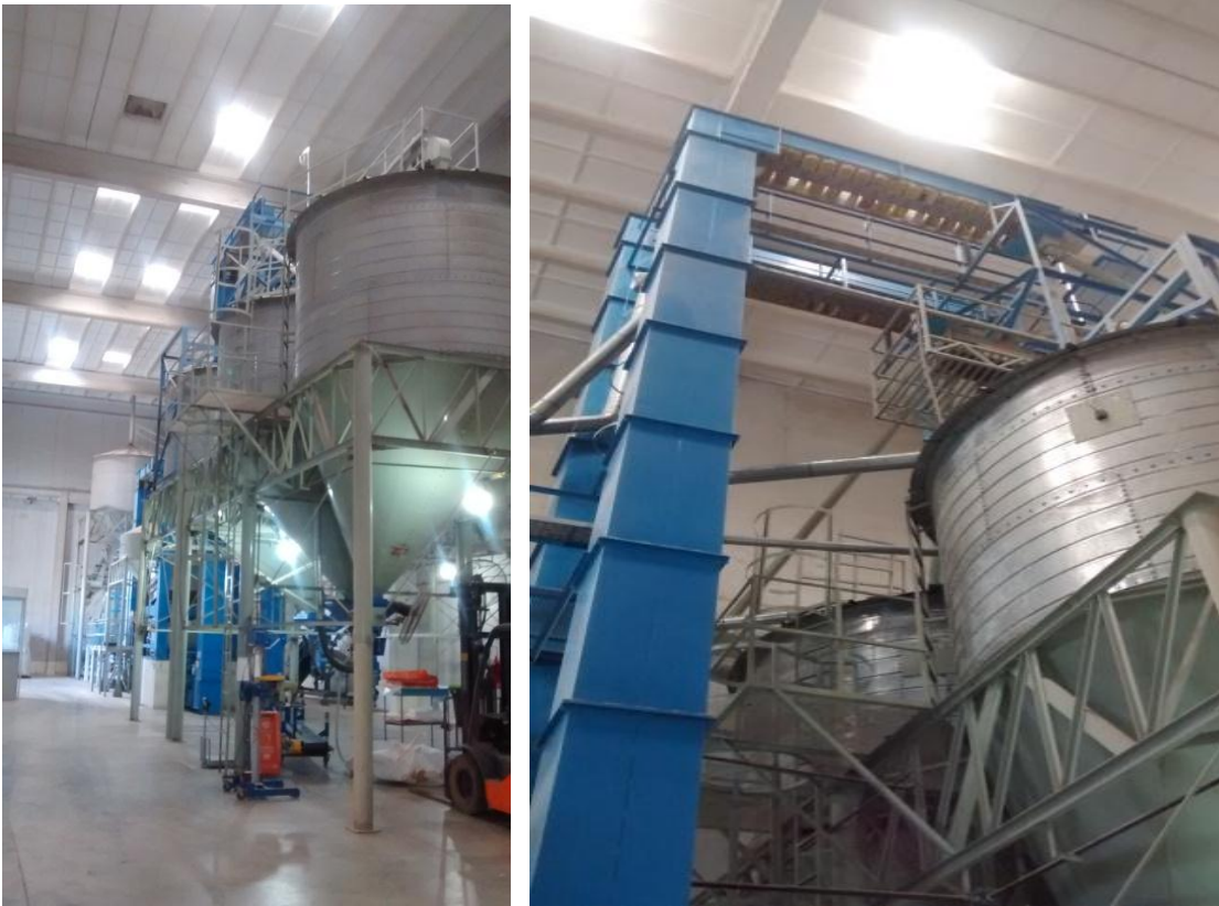
Figura 17 y 18: Sistemas de cangilones elevando los granos hacia los silos de producto terminado.
