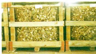
Figura 4 - Bins hiper ventilados lateralmente para secado forzado de ajo con aire forzado en túneles con ajo en media rama en su interior
