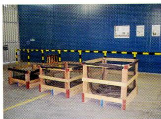
Figura 3 - Bins hiperventilados lateralmente para secado forzado de ajo con aire forzado en túneles con circulación de aire en sentido horizontal.
