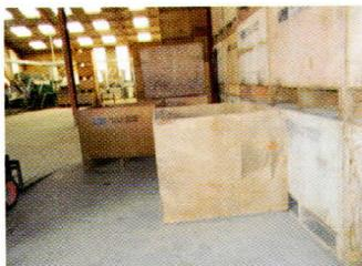
Figura 2 - Ordenamiento de bins con piso cribado y paredes "ciegas" para secado de ajo con aire forzado en sentido vertical.
