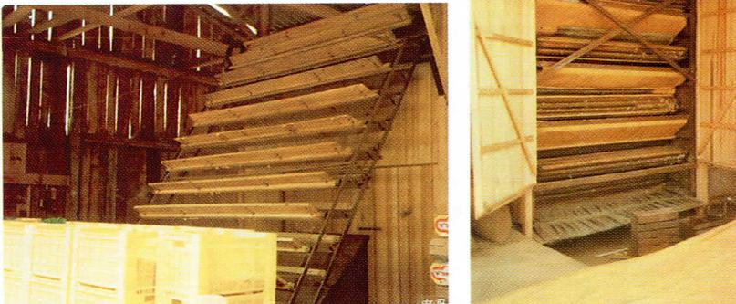
Figura 7 - Vista de zona de carga superior y descarga inferior de túnel de secado de cinta continua.
