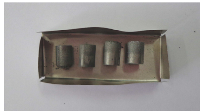
Figura 2.16. Compactos en verde dentro de navetilla de titanio
