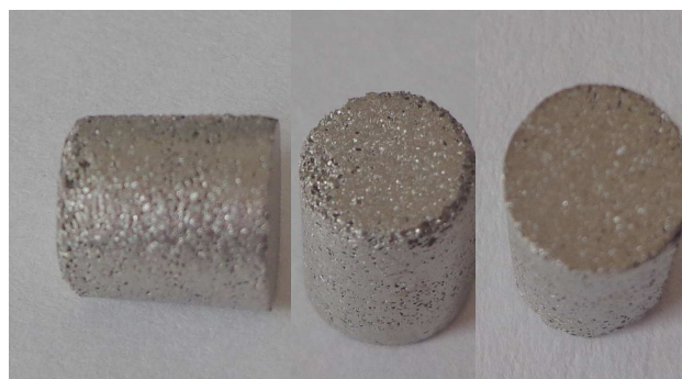
Figura 2.21. Vistas de compactos de 50% de porosidad en distintas posiciones
