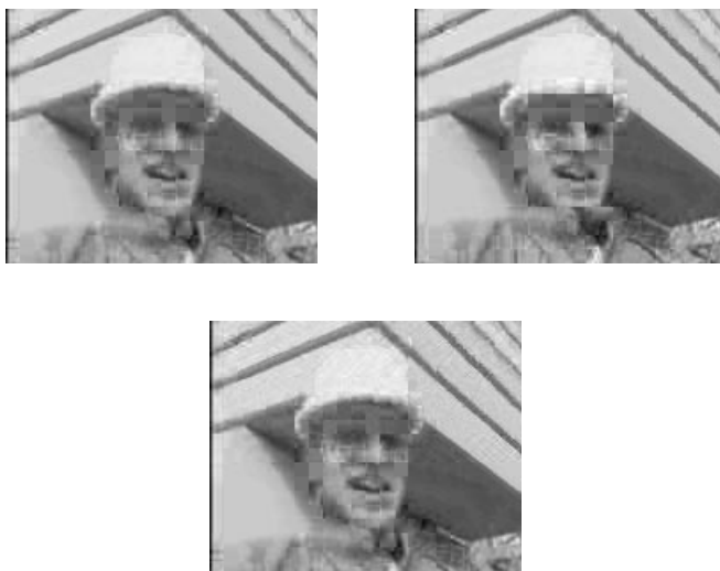
Fig 6-39: Calidad del vídeo reproducido para la secuencia “Foreman” usando NSVBR y CVQR. Cuadro codificado nro. 44: original (izquierda), NSVBR (derecha) y NSVBR+ CVQR (centro). Demora de ida y vuelta N_D = 6 . Velocidad de transmisión RS2 ( R_v=15.6 kbps). Estado del canal “Bueno”.
