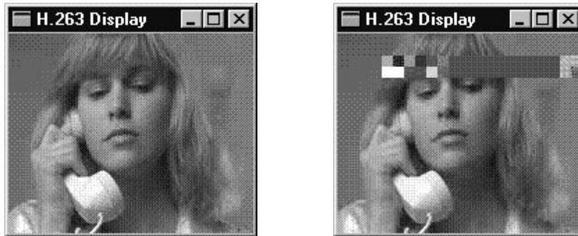
Fig. 1-3: Efectos de los errores en un cuadro de vídeo comprimido sin predicción (intra). Cuadro original (izquierda) y reconstruido con un bit con error (derecha).
