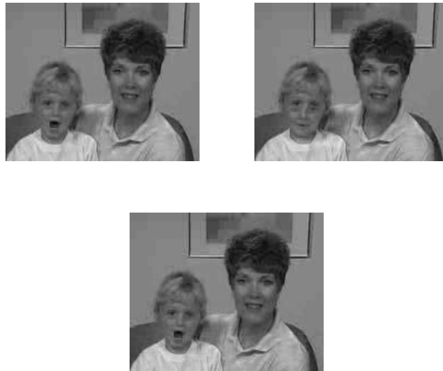
Fig 6-37: Calidad del vídeo reproducido para la secuencia “ Mother&Daughter ” usando NSVBR y CVQR. Cuadro codificado nro. 45: original (izquierda), NSVBR (derecha) y NSVBR+ CVQR (centro). Demora de ida y vuelta N_D = 6 . Velocidad de transmisión RS2 ( R_v=15.6 kbps). Estado del canal “ Bueno ”.
