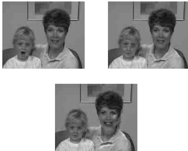
Fig 6-28: Calidad del vídeo reproducido para la secuencia “ Mother&Daughter ” usando NSVBR. Cuadro codificado nro 45: original (izquierda), NSVBR (derecha) y sin protección (centro). Demora de ida y vuelta N_D = 6 . Velocidad de transmisión RS2 ( R_v=15.6 kbps). Estado del canal “ Bueno ”.
