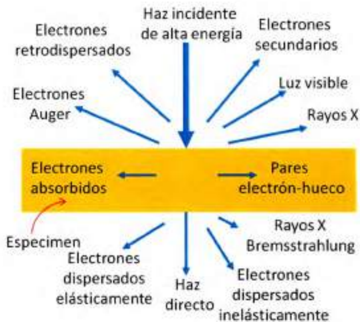
Figura 2.1 . Señales generadas cuando un haz de alta energía de electrones interactúa con un espécimen fino. La mayoría de estas señales pueden ser detectadas en diferentes tipos de microscopías de electrones
