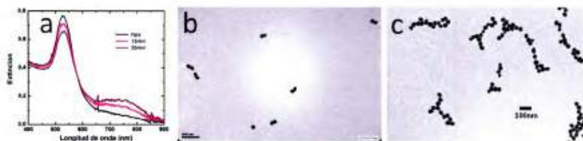
Figura 6.3 . a) Espectros de extinción de NPs de 35 nm de diámetro diferentes tiempos de agregación después de la adición de 4 \times 10^{-11} \text{M} de complejo de tris(5-amino-1,10-fenantrolina)rutenio(II). Imágenes TEM en dos estadios del proceso de agregación b) 13 minutos y c) 35 minutos.
