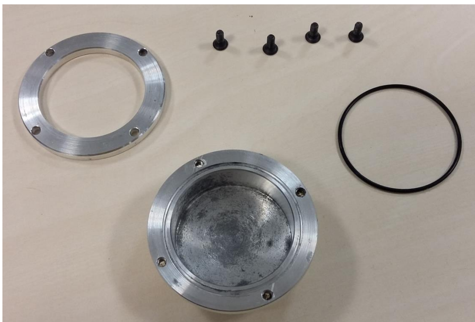
Fig. 2.04. Dispositivo para la determinación de la tasa de transmisión de vapor de agua (WVT) y permeabilidad.
