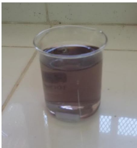
Fig. 3.01. Mezcla de reacción conteniendo quitosano, sorbitol al 5% en peso y ácido gálico 0,75% en peso.
