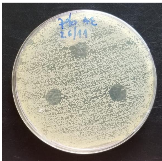
Fig. 5.08. Imagen representativa de zona de inhibición de película a base de quitosano/aceite esencial de limón/Tween 80 contra E. coli .
