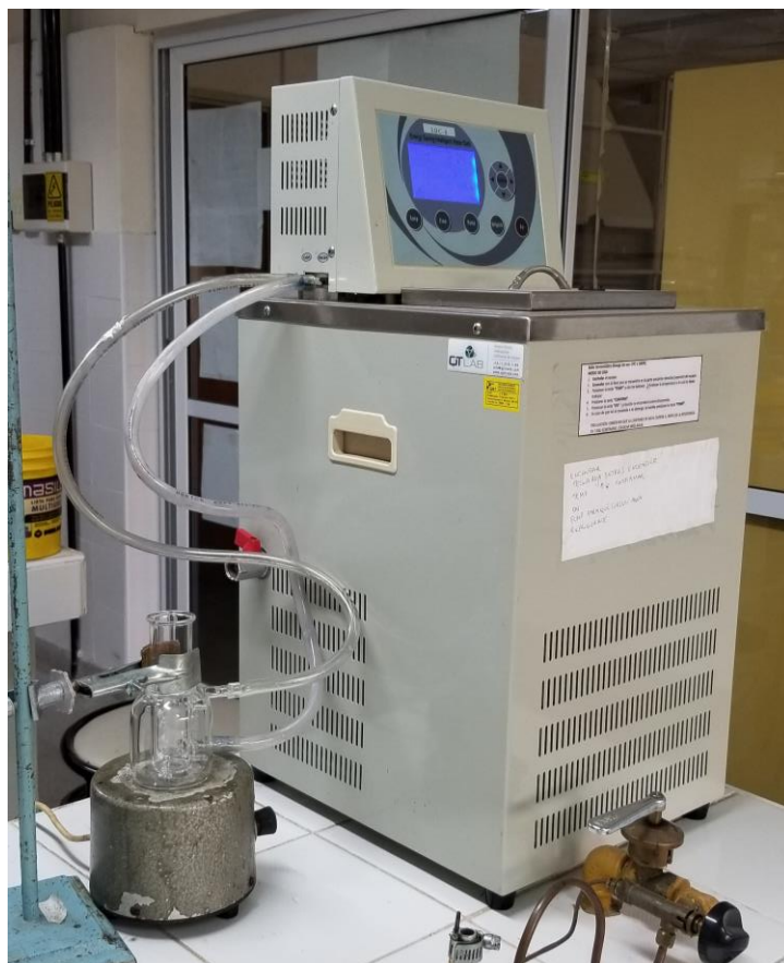
Fig. 4.01. Celda encamisada conectada a baño termostático para modificación de condiciones de reacción.
