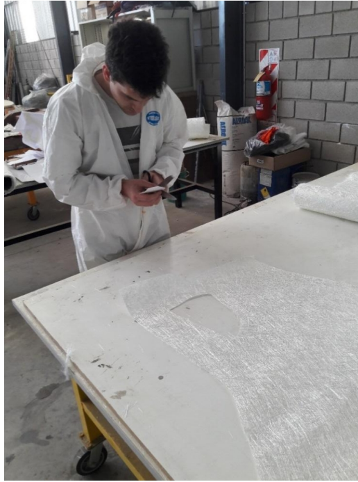
Figura 1.1. Operario recortando fibra
