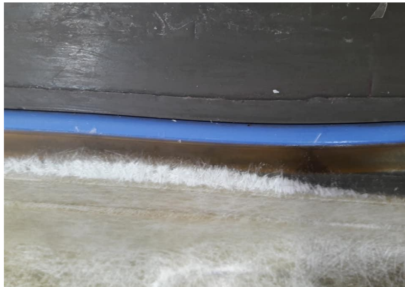
Figura 1.2. Invasión del material refuerzo en la zona de contacto entre moldes
