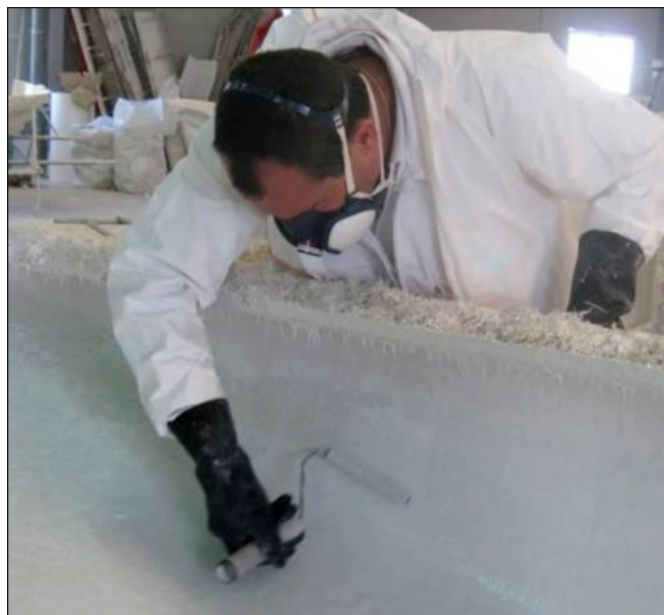
Figura 4.39. Operario laminando manualmente a molde abierto.
