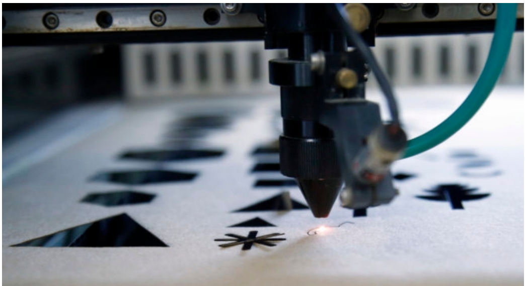
Figura 2.8. Corte Láser sobre papel madera.
