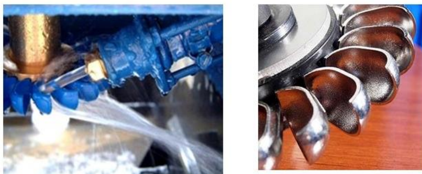
Figura 24: Posición del chorro en una turbina Turgo y un rotor tipo (Ref: http://www.varspeedhydro.com/Turgo.html ).
