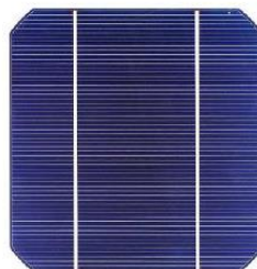
Silicio monocristalino: Un solo cristal. Se fabrica en lingotes. Son las más producidas. Eficiencia: 15 al 18%.
