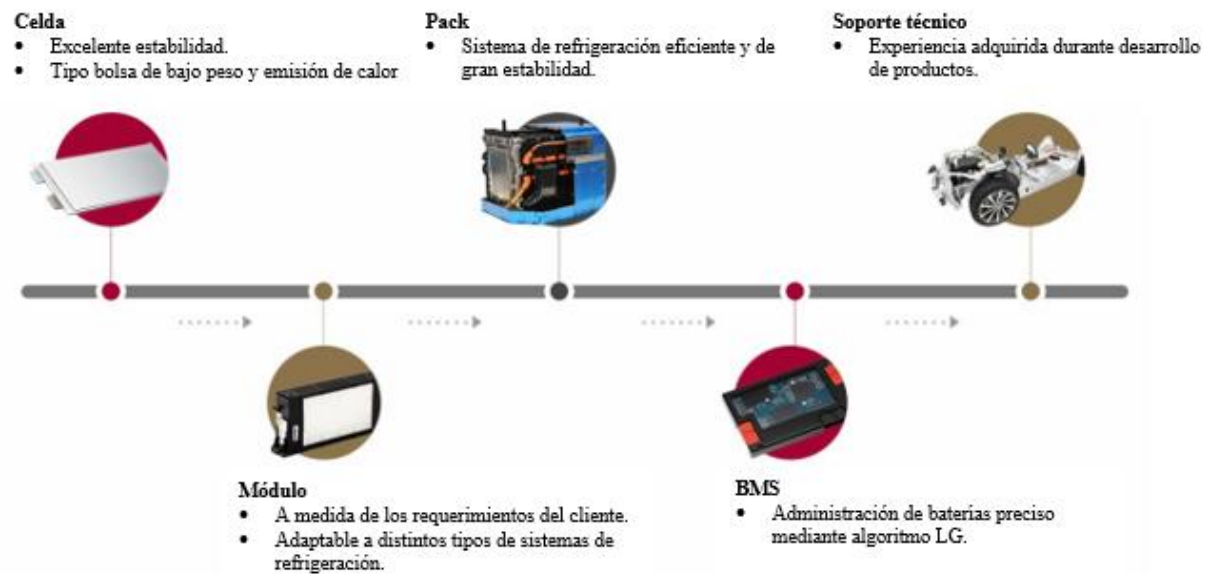
Ilustración 22 - Elementos de un pack para VE. Fuente: LG Chem
