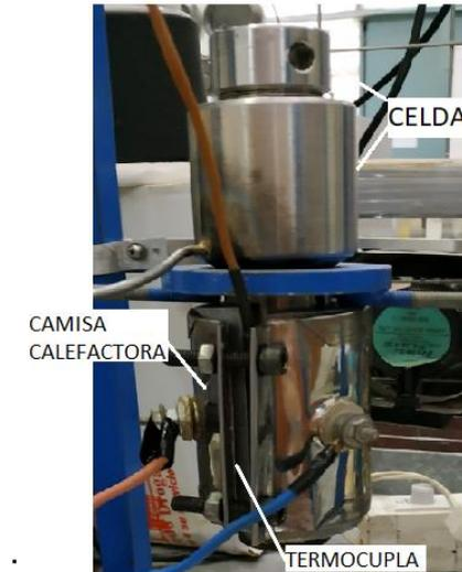
Figura 14. Celda de impregnación a alta presión (IDTQ-FCEFYN-UNC)
