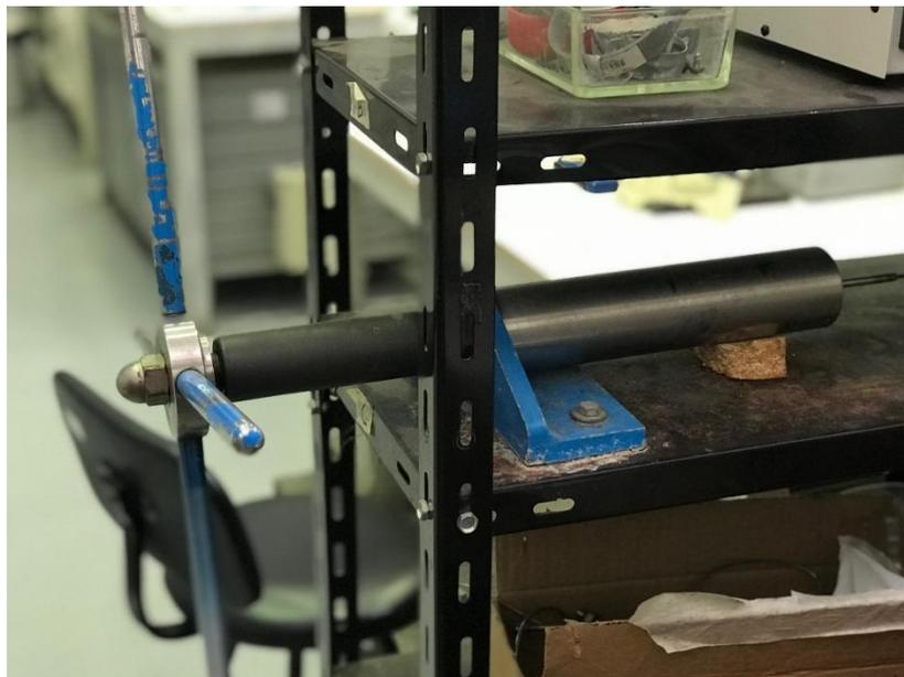
Figura 15. Generador de presión.
