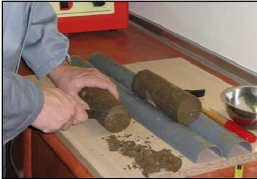
Figura 2.8: Tallado de probeta para ejecución de ensayo de laboratorio a partir de muestra de suelo inalterado.
