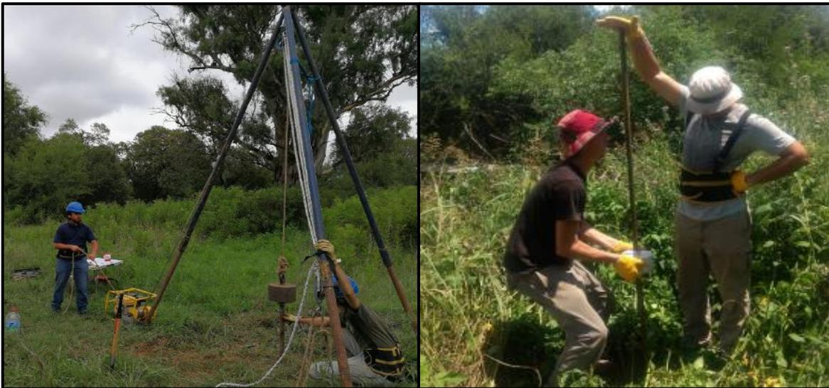
Figura A.3: a) Ejecución de ensayo SPT en Alta Gracia. b) Ejecución de ensayo DPL en Villa Anisacate.
