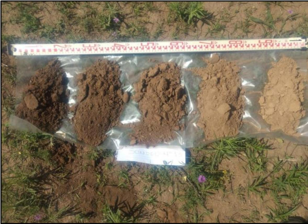
Figura 2.7: Fotografía de campo, muestras alteradas extraídas de una misma perforación para evidenciar evolución del contenido orgánico del suelo.
