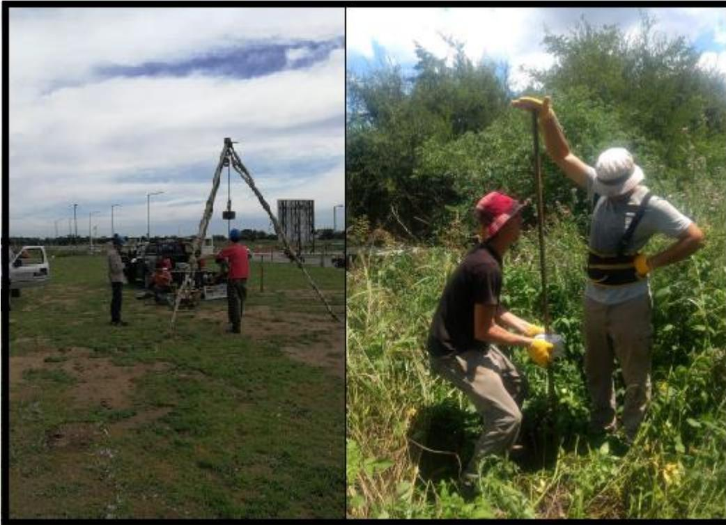
Figura 3.1: a) Ejecución del ensayo SPT b) Ejecución ensayo DPL.
