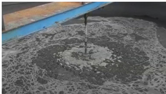
Figura 2. 17 - Homogeneizador cilíndrico con agitación mecánica
