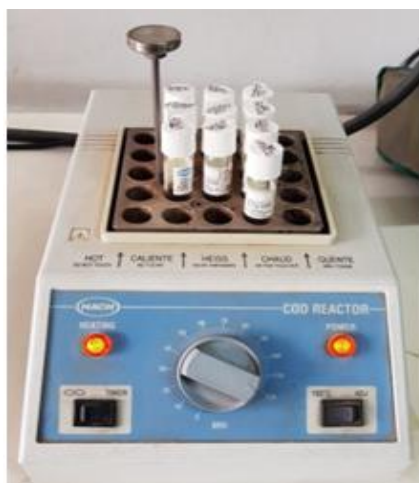
Figura 2. 13 - Incubadora electrónica para ensayos de DBO y DQO
