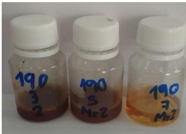
Figura 19. Muestras extraídas a 190 °C a tiempo de 3, 5 y 7 mL/min
