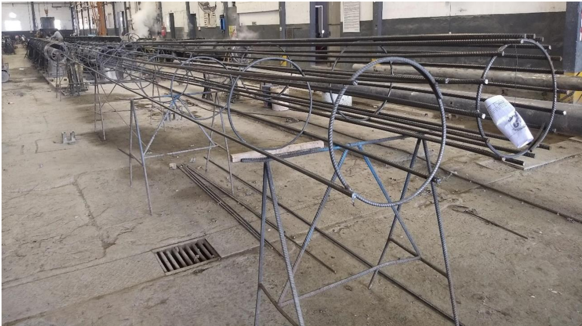
Imagen 5.3. Imágenes de dos canastos de las mismas características, el de la izquierda en proceso de fabricación, mientras que el de la derecha ya está concluido y en condiciones de enviar al próximo sector productivo.
