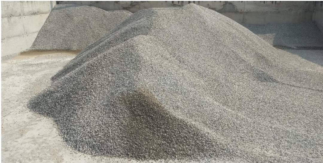
Imagen 2.5. Box de acopio de triturado 3/8mm.
