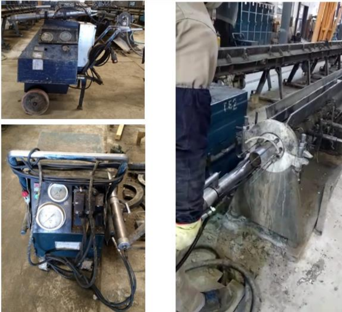
Imagen 5.7. Maquina tensadora y operario realizando esta tarea sobre el molde de un poste.
