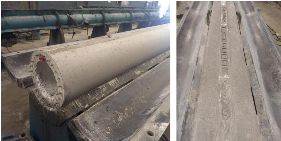
Imagen 5.12. Poste de media tensión posterior a la apertura de molde.
