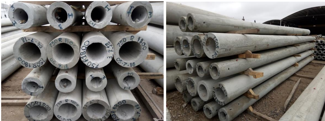
Imagen 5.15. Estiba de postes en playa de acopio.
