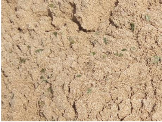
Imagen 2.9. Muestras de contaminaciones de materia orgánica y terrones de arcilla en arena gruesa.
