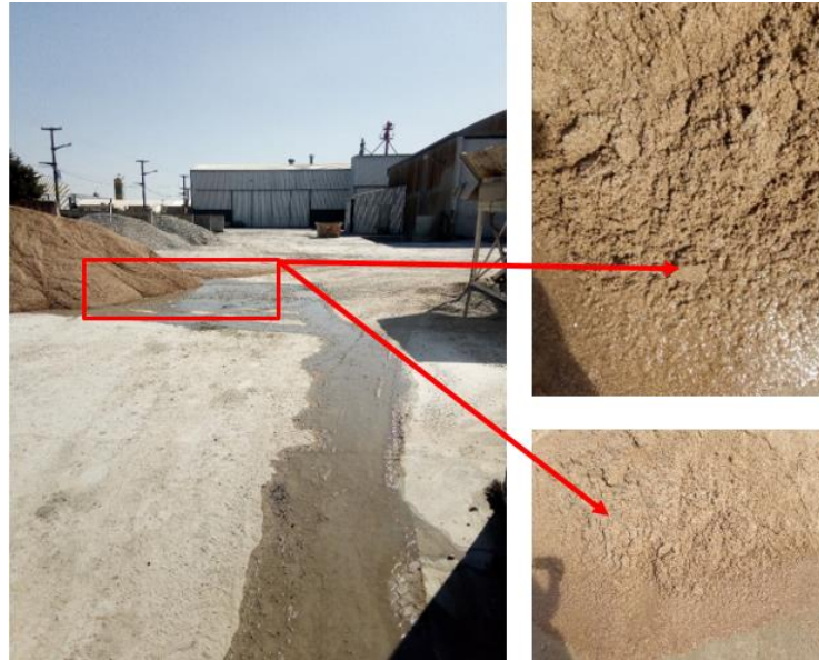
Imagen 2.10. Arena gruesa saturada en agua.
