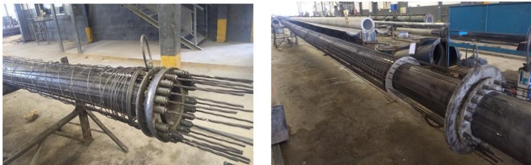
Imagen 5.4. Imágenes de la estructura de un poste de media tensión, previo a ser montado en el molde.
