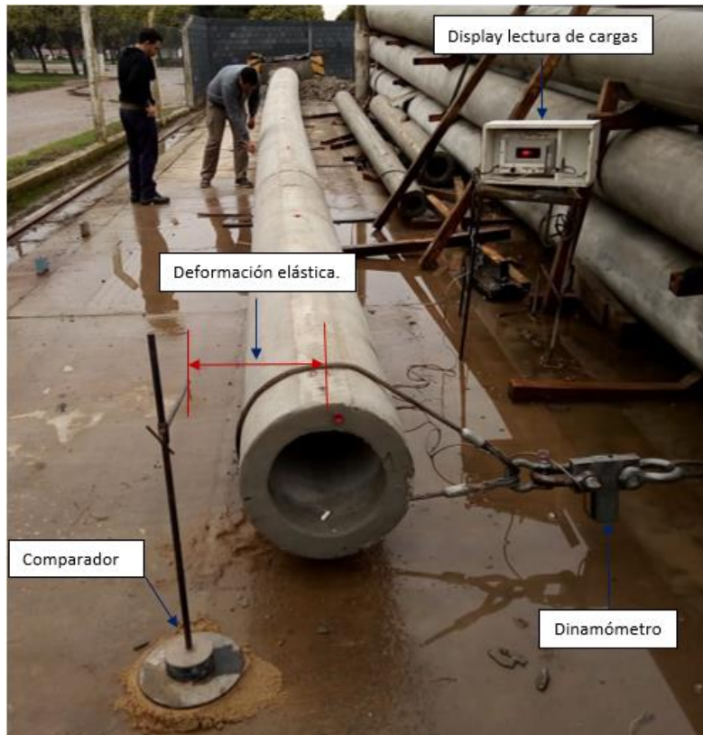
Imagen 6.3. Ensayo a flexión de postes.
