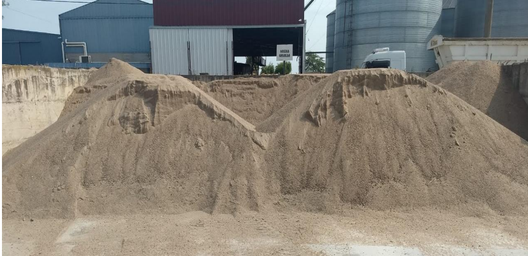
Imagen 2.3. Box de acopio de arena gruesa.
