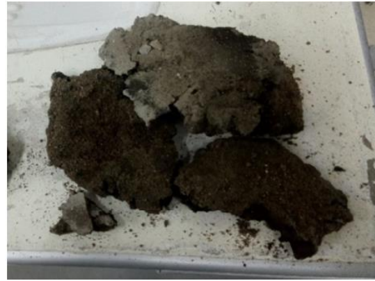
Imagen 2.9. Muestras de contaminaciones de materia orgánica y terrones de arcilla en arena gruesa.
