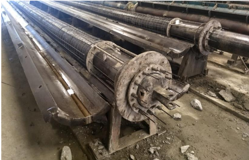
Imagen 5.5. Estructura de postes sobre moldes de media tensión.
