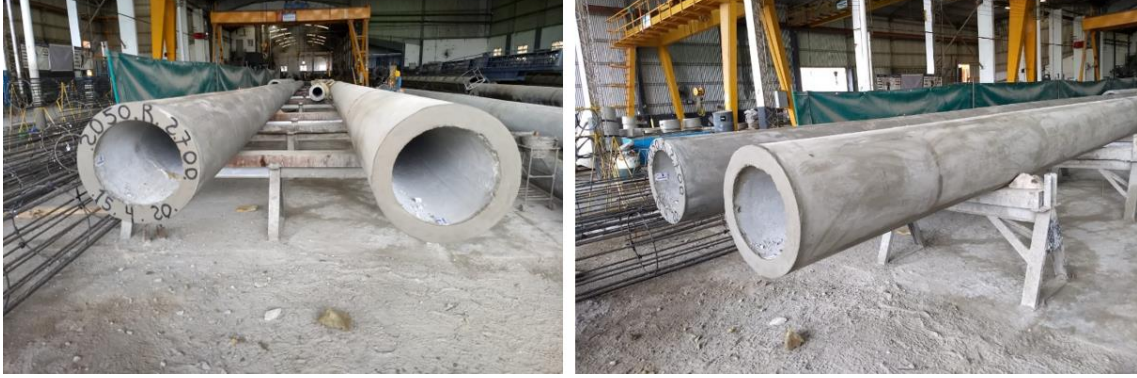
Imagen 5.13. Banco de curado de postes.
