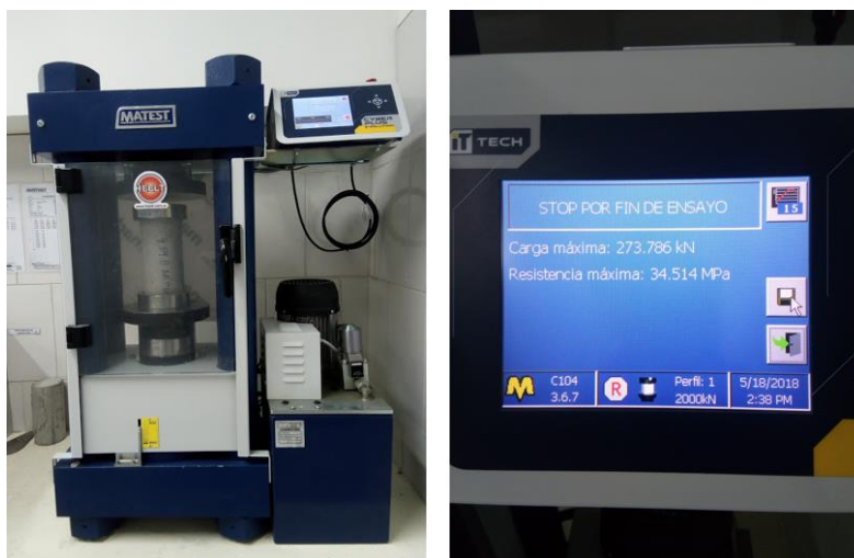
Imagen 4.3. Prensa automática MATEST con display.
