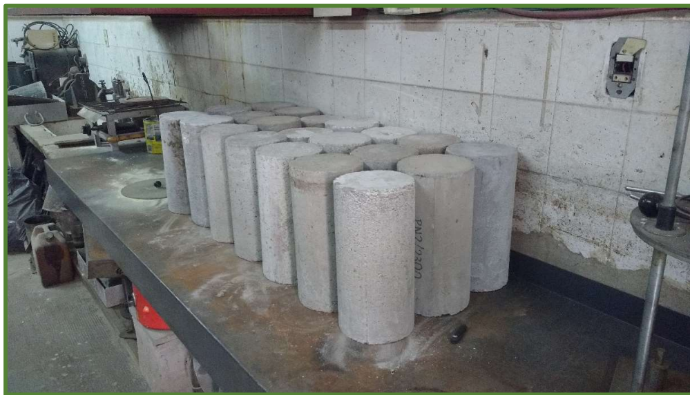
Figura 80 - Recepción de probetas de Hormigon
