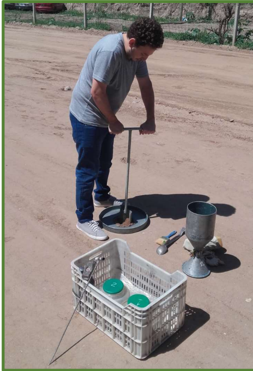
Figura 57 - Realización del hueco
