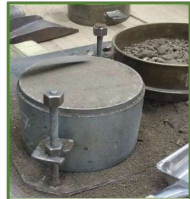
Figura 53- Enrasado (Elab Propia)
