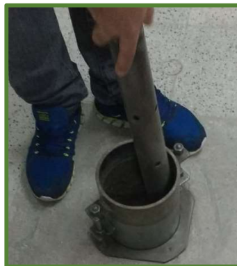
Figura 54 - Accion de compactacion con el pison (Elab Propia)
