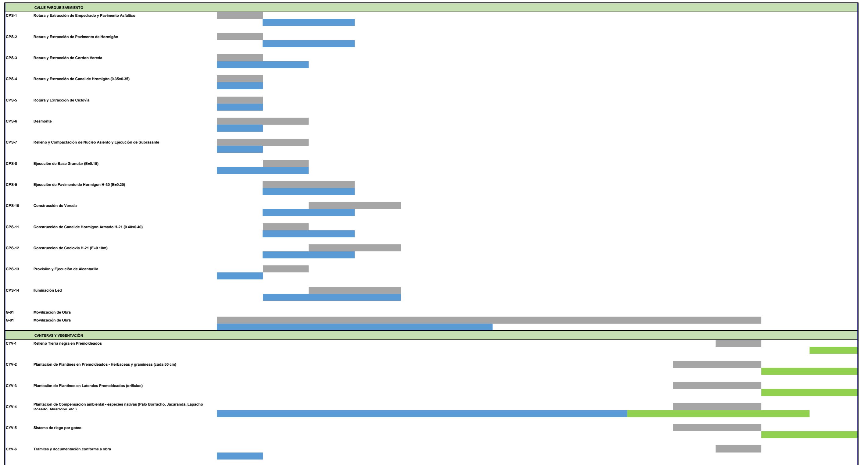
Fig. 3.26. Plan de avance teórico inicial, Plan de avance real y Plan de avance teórico planteado con ampliación de plazo. Fuente: Elaboración propia en base a datos brindados por la empresa AFEMA S.A.
