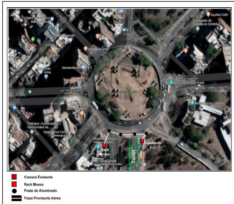
Fig. 3.20. Traza de contingencia para desvío de Fibra Óptica.
