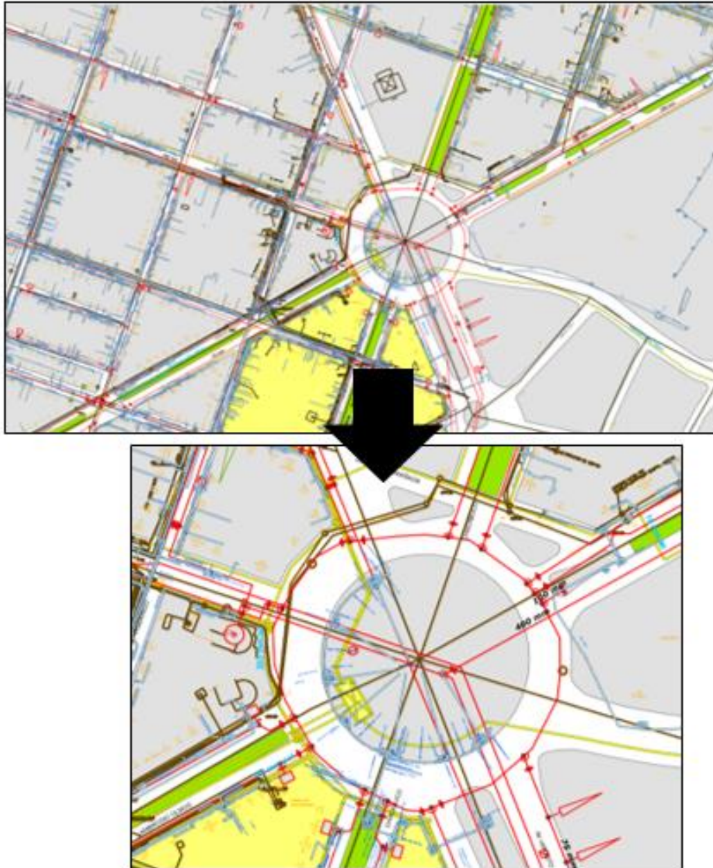
Fig. 3.1. Interferencias en plaza España y alrededores. Fuente: Elaboración propia en base a planos de proyecto de AFEMA S.A.
