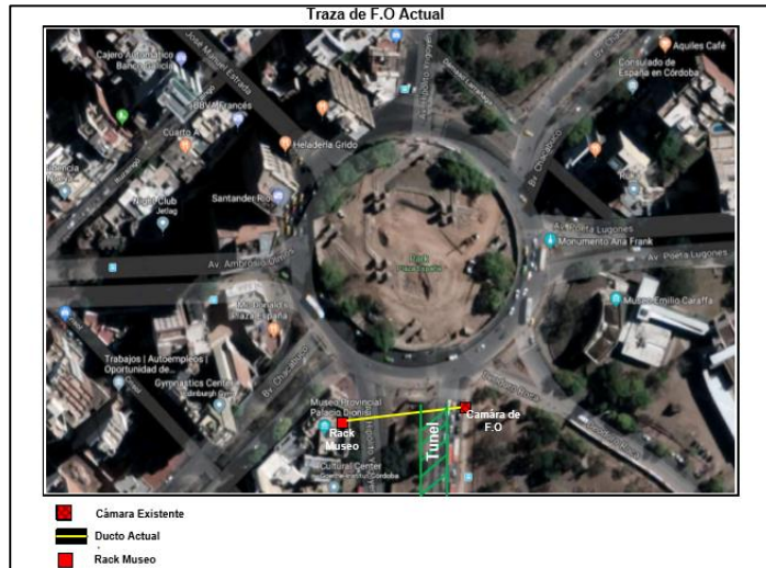
Fig. 3.19. Líneas existentes de Fibra Óptica del Gobierno. Fuente: Elaboración propia en base a planos de proyecto de AFEMA S.A.
