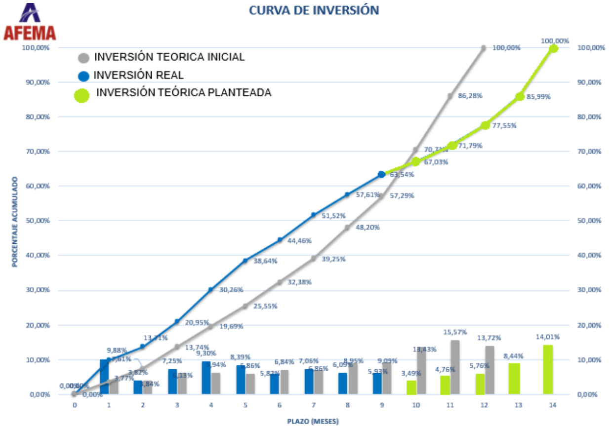
Fig. 3.27. Curva de inversión teórica inicial, curva de inversión real y curva de inversión teórica planteada con ampliación de plazo.
