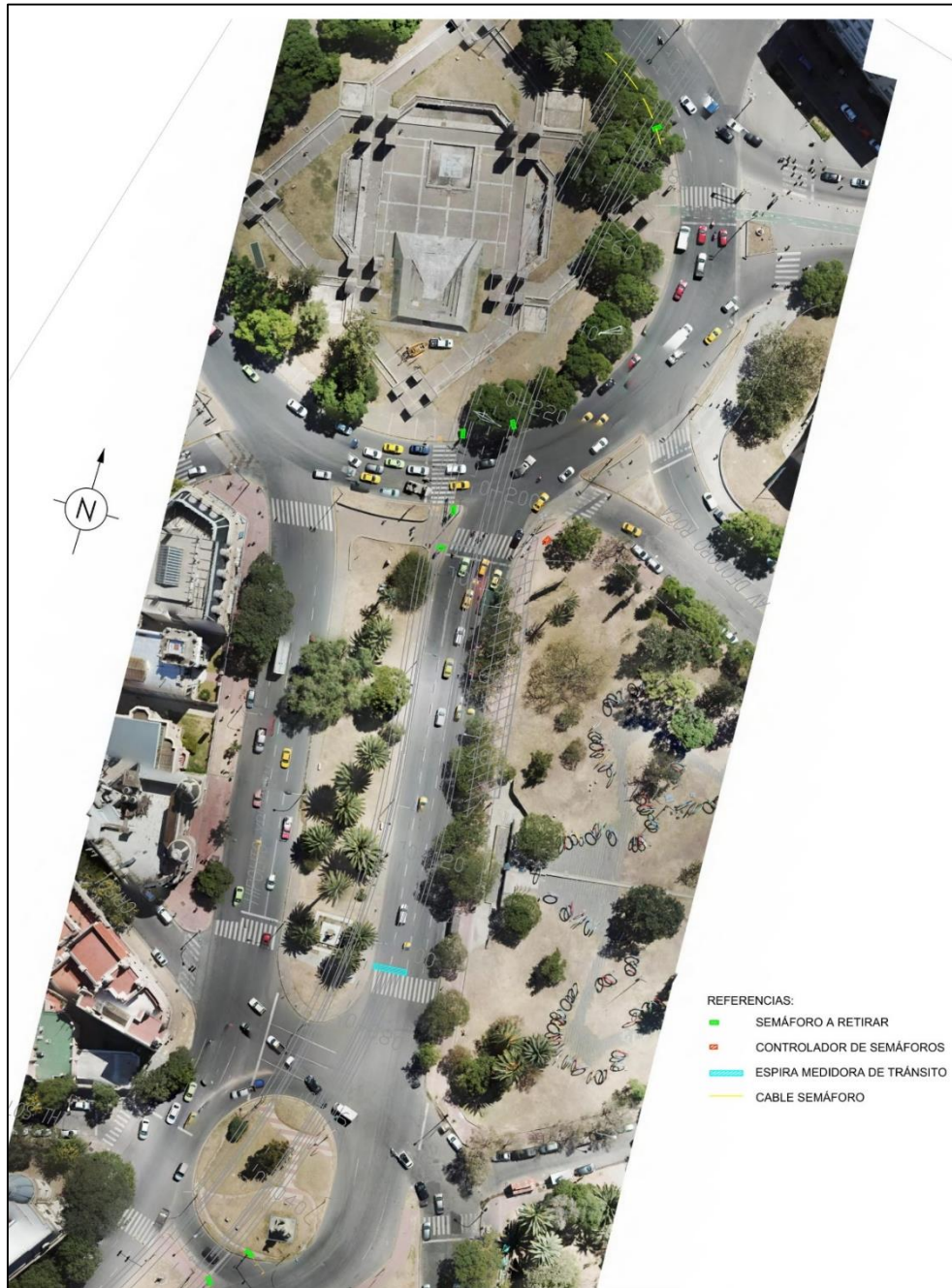
Fig. 3.7. Planimetría general con semáforos a retirar. (PLANO N°13)
