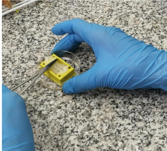
Figura 44: posicionamiento de la matriz sobre el pocillo de la cámara de estiramiento.
