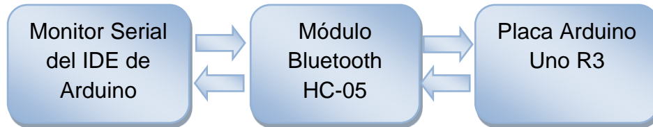
Figura 22: comunicación entre la PC y la placa Arduino con módulo Bluetooth.
