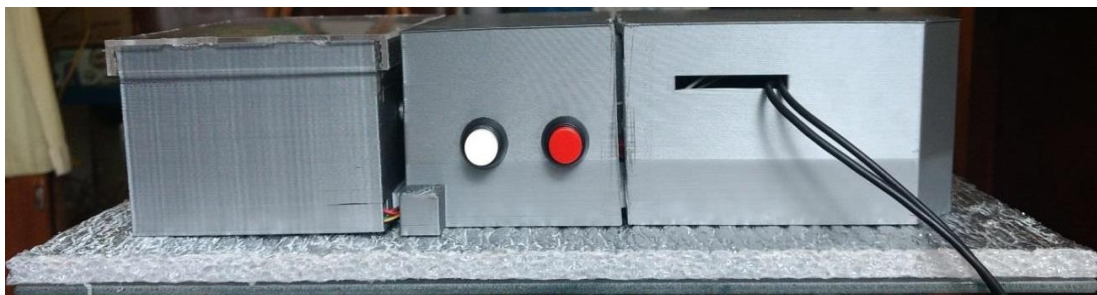
Figura 50: montaje final del biorreactor mecánico.
