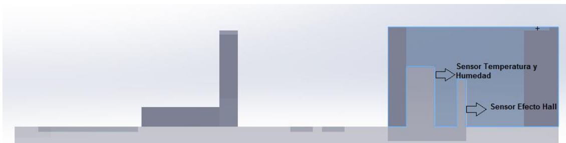
Figura 25: orificios para los sensores de temperatura y humedad y de final de carrera (Hall).
