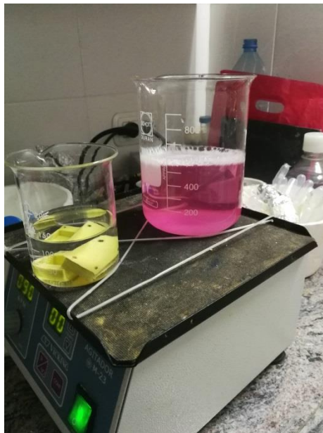
Figura 43: desinfección de las cámaras de estiramiento y homogeneización del monopersulfato de potasio.
