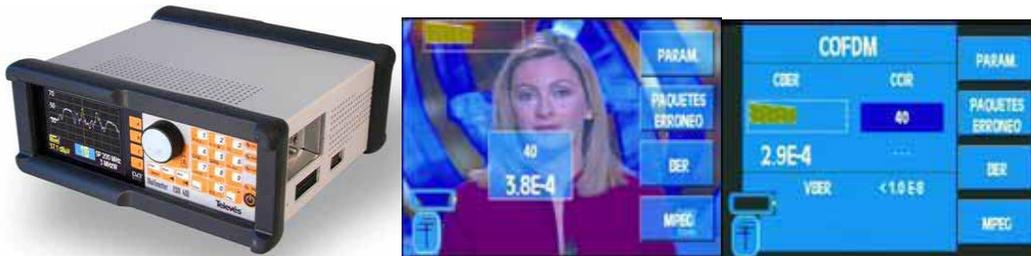
Pantallas del medidor FSM para medida del CBER
