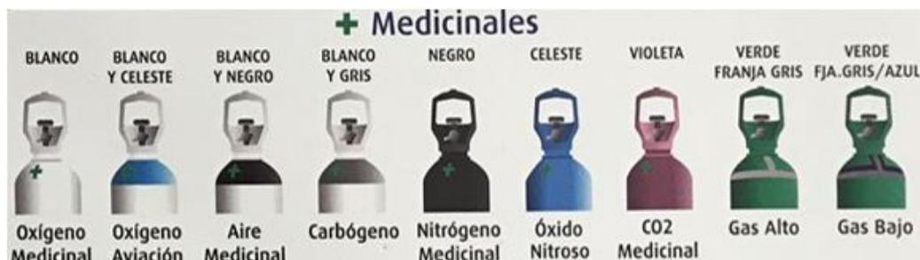
Figura 2.1: Código de colores para la identificación de cilindros de gases medicinales
