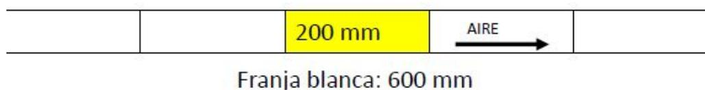
Figura 2.2: Marcado de cañería según Norma ISO N°5359:2014
