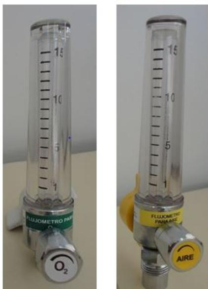
Figura 7.1: Caudalímetro para Oxígeno Medicinal y caudalímetro para Aire Comprimido Medicinal
