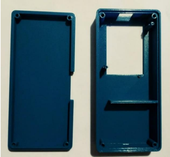
Ilustración 51: Carcasa Impresa - Vista Inferior
