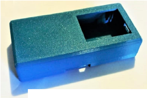
Ilustración 53: Carcasa Impresa Ensamble - Vista Axonométrica
