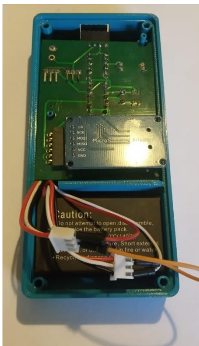
Ilustración 54: Prototipo Radiómetro - Vista Inferior
