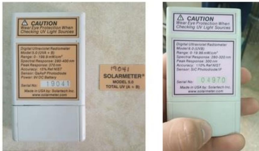
Ilustración 60: Radiómetros Utilizados como Patrón de Calibración
