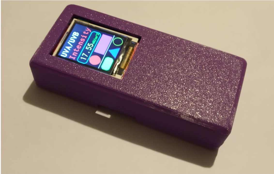
Ilustración 59: Prototipo Radiómetro UVA en Funcionamiento - Vista Axonométrica
