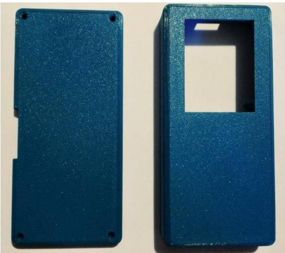
Ilustración 52: Carcasa Impresa - Vista Superior
