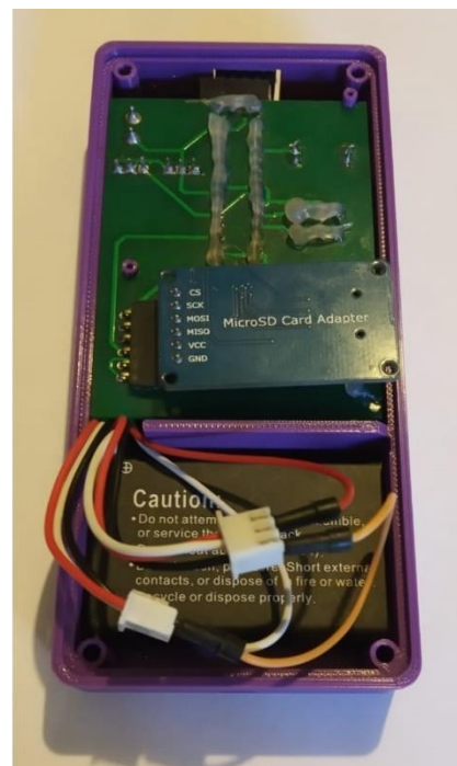
Ilustración 54: Prototipo Radiómetro - Vista Inferior
