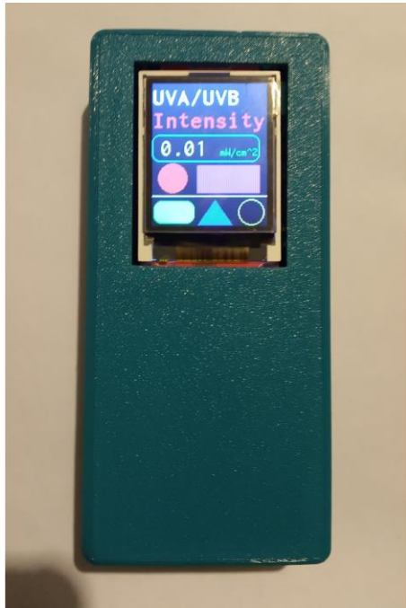
Ilustración 57: Prototipo Radiómetro en Funcionamiento - Vista Superior
