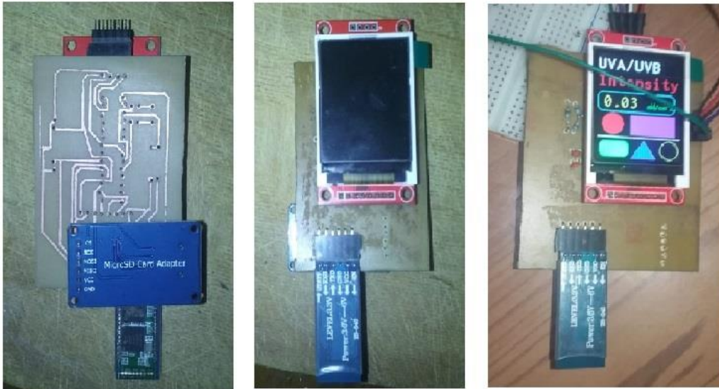
Ilustración 40: Placas de Cobre Impresas para Pruebas de Módulos Periféricos
