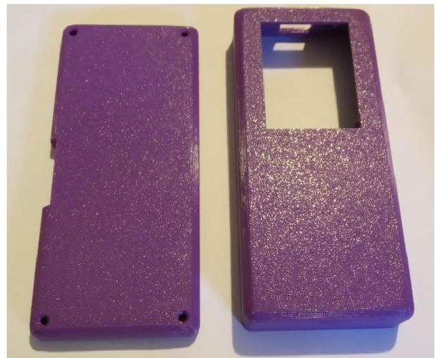
Ilustración 52: Carcasa Impresa - Vista Superior
