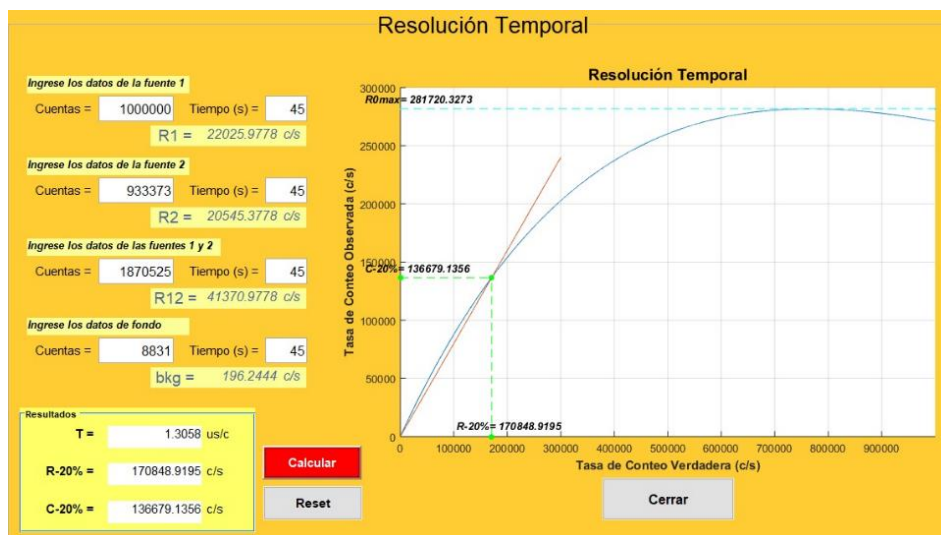
Figura 43 - Software para la determinación de la operación de la tasa de conteo.
