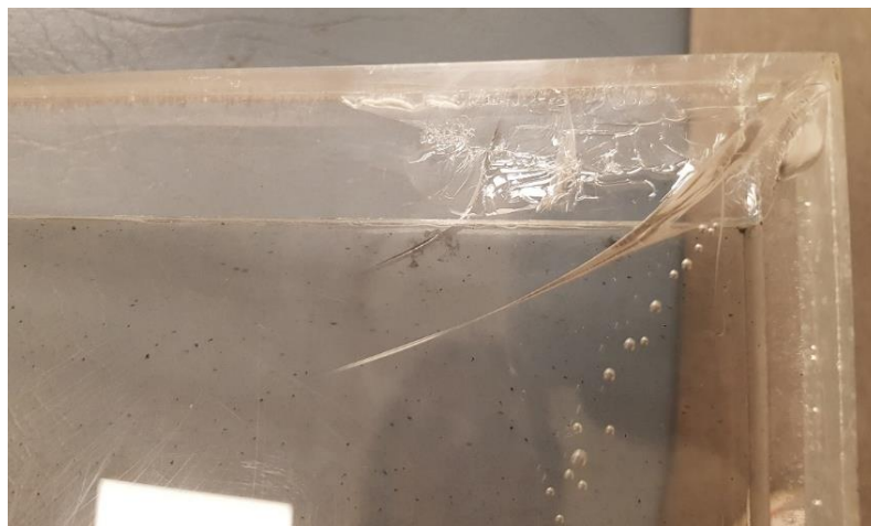
Figura 33 - Maniquí de inundación del campo del equipo Siemens c.cam. Puede apreciarse la fractura del material, así como el ingreso de aire al líquido contenido dentro del mismo.
