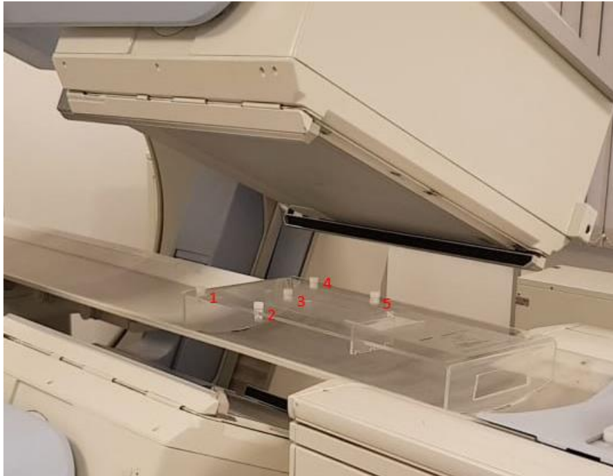
Figura 45 - Disposición de las fuentes de ^{99m}\text{Tc} para el estudio de CoR de la cámara Siemens e.cam con colimadores de baja energía y alta resolución (LEHR). La prueba corresponde a una disposición de los cabezales de 180°. Puede observarse el soporte provisto por el fabricante sobre el cual se colocan las fuentes radiactivas puntuales. Para el estudio con colimadores de alta energía (Hi-En), las fuentes nro. 2 y 4 son removidas.
