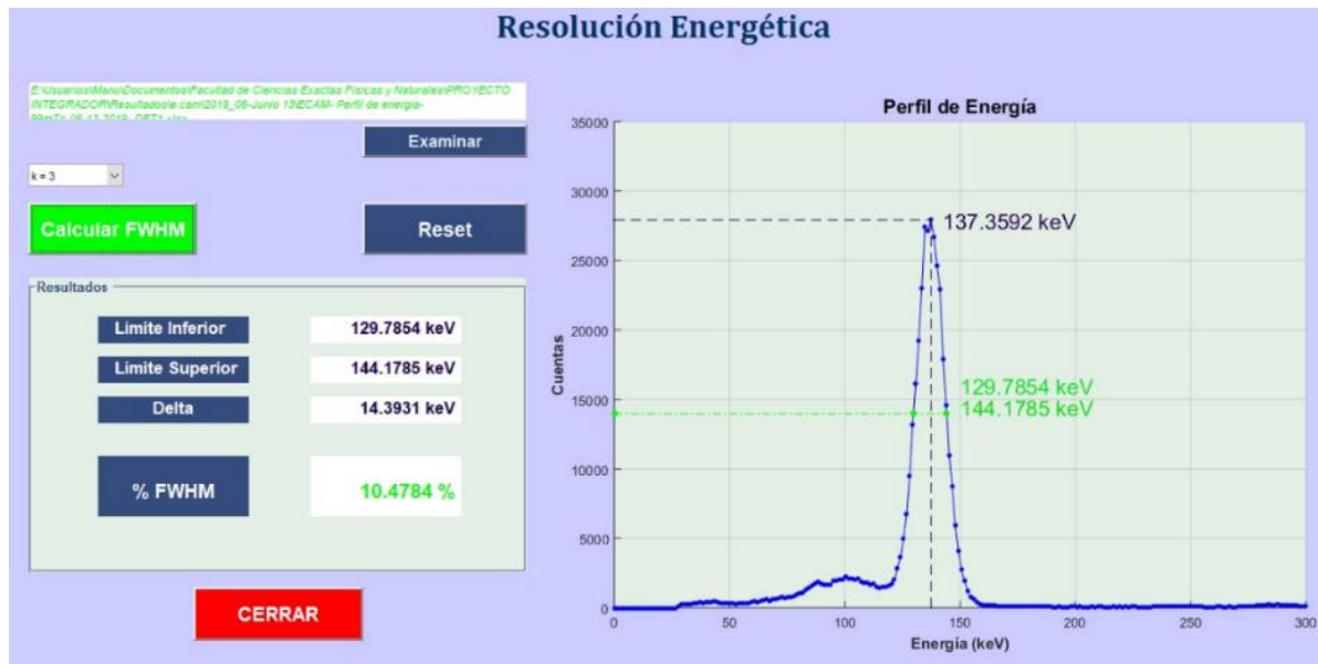
Figura 42 - Software para la determinación de la resolución energética del equipo Siemens e.cam. Los datos son exportados del equipo en formato .xlsx e importados en el software.
