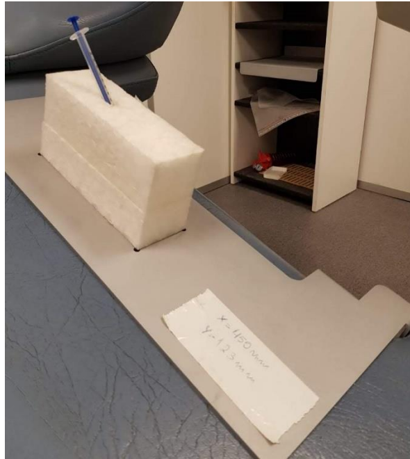
Figura 44 - Disposición del soporte de CoR durante la prueba del centro de rotación en el equipo Siemens c.cam. El mismo es colocado sobre la camilla del equipo.
