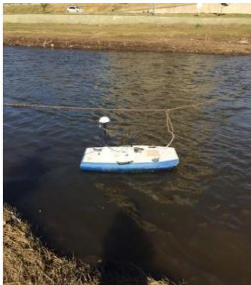
*Figura 25: Medición de caudales con ADCP desde plataformas móviles comandadas con cables*
