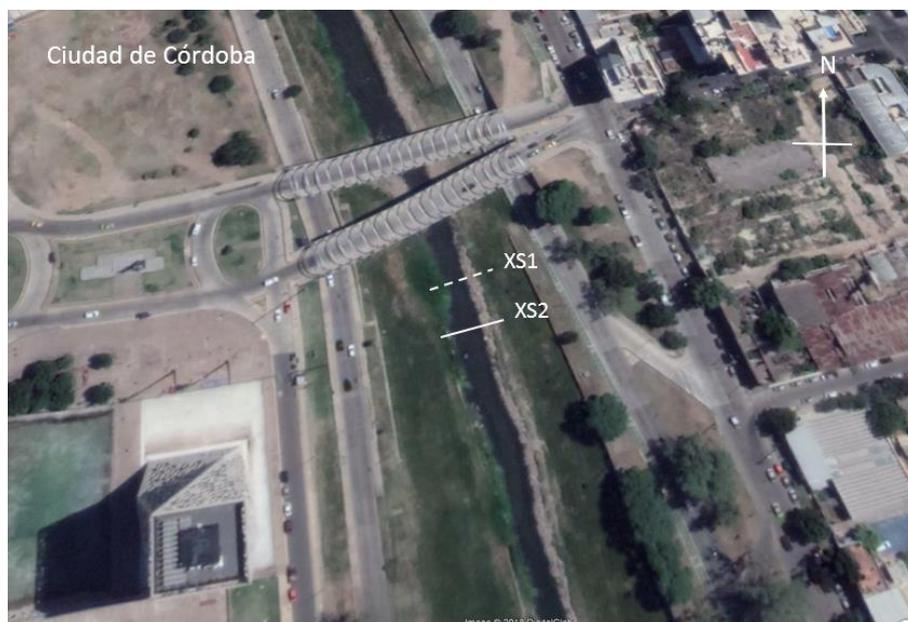
*Figura 87: Ubicación de sección medida con ADCP (línea continua) y ADV-LSPIV-STIV (línea de trazo) en el Río Suquía durante la regata.*
