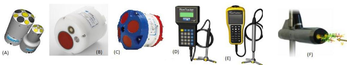
Figura 83: Instrumentos utilizados en la regata, (A) ADCP SonTek M9 y S5; (B) ADCP RDI RiverRay; (C) ADCP RDI Rio Grande; (D) SonTek FlowTracker 1; (E) SonTek FlowTracker 2; (F) OT ADC
