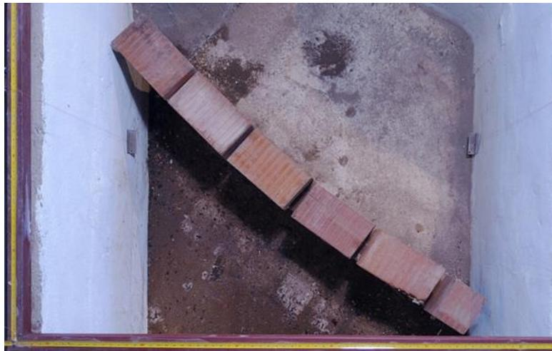
Figura 62: Deflector dentro del modelo físico del Dique los Alazanes - LH-UNC.
