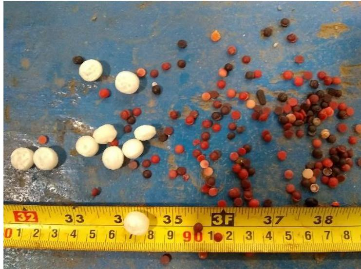
*Figura 29: Partículas de cera y de poliestileno expandido utilizadas como trazadores*
