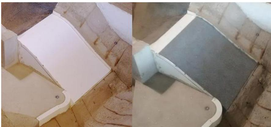
*Figura 53: Rápida del vertedero de descarga. Derecha: Con arena ( $d_{50} = 2\text{mm}$ ). Izquierda: Sin revestimiento.*
