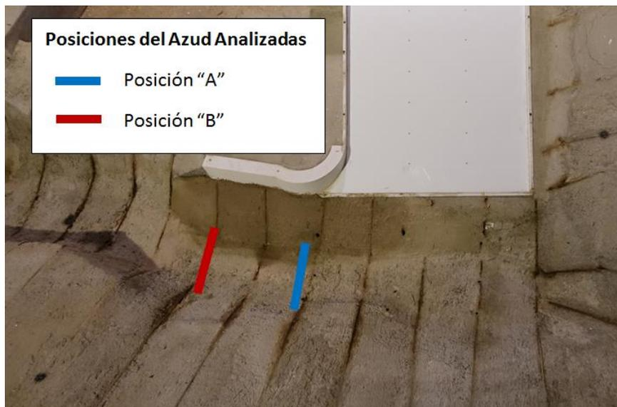
*Figura 54: Posiciones del azud aguas abajo del vertedero evaluadas.*
