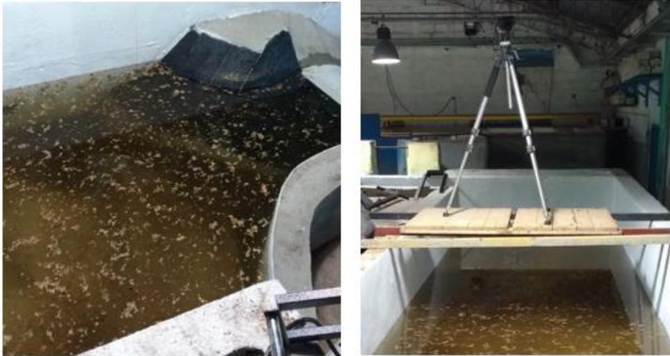
*Figura 55: Izquierda: Zona de aproximación con sembrado de virutas de madera. Derecha: Cámara digital sobre plataforma para registrar videos de la zona de aproximación.*
