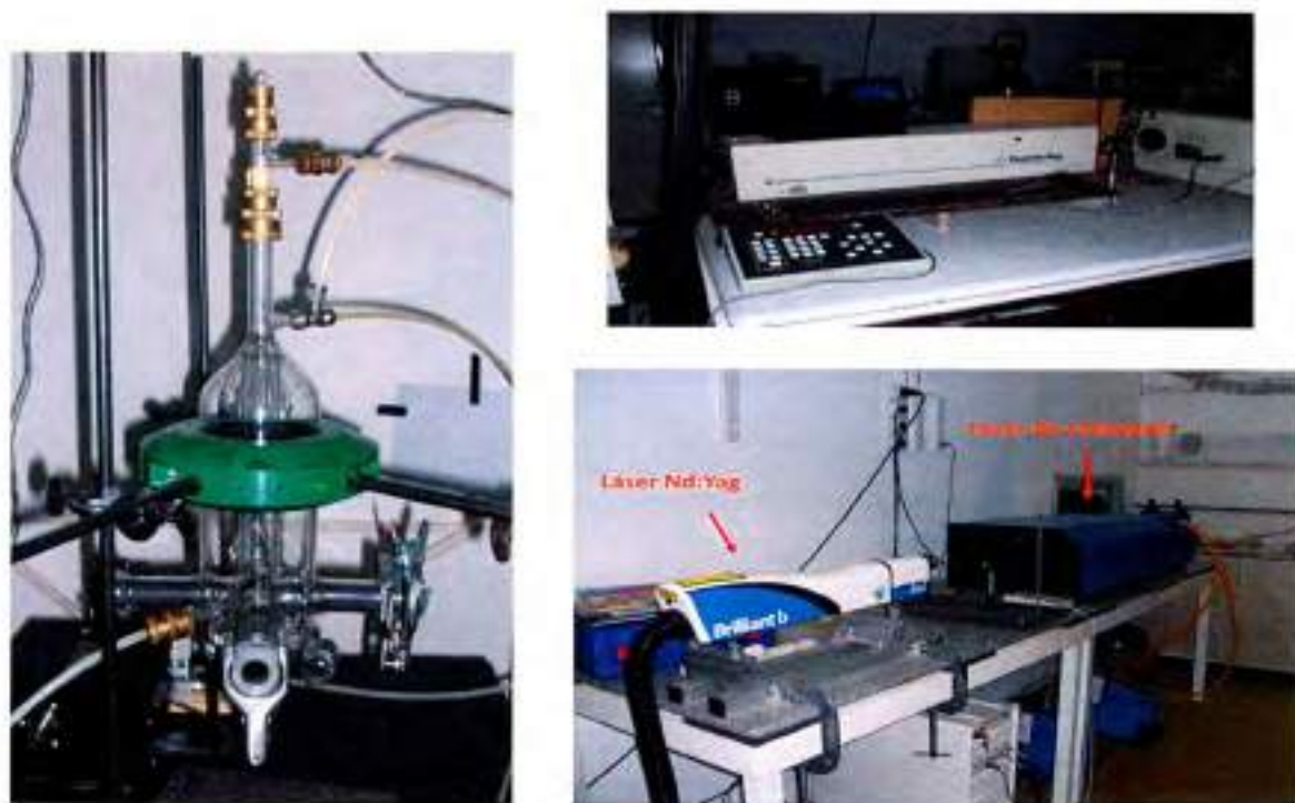
Figura AII.1: A la izquierda: la celda de fotólisis. Derecha arriba: láser de Nd-Yag utilizado para la fotólisis del \text{H}_2\text{O}_2 . Derecha abajo: Láser de excitación, láser de colorante (Dye) marca Syrah Cobra Stech bombeado con un Nd-Yag marca Brillant B
