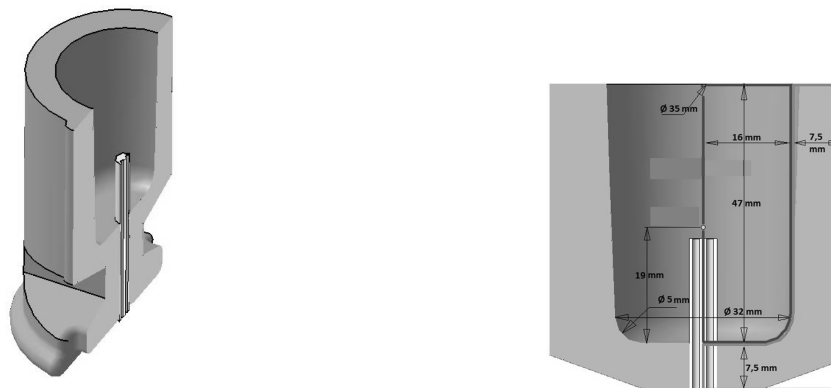
(a) Perspectiva tridimensional de media sección de la copa (b) Vista frontal del molde con la termocupla y el bifilar
