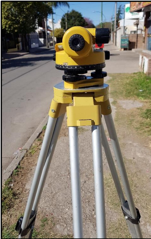
Figura 2.3.1.2 – Trabajo en campaña con Nivel topográfico (Fuente: Elaboración propia)
