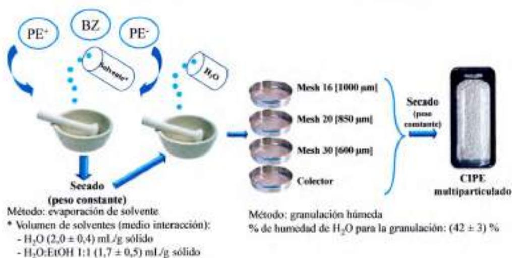
Figura 4.1. Esquema de la metodología de obtención de los CIPE multiparticulados
