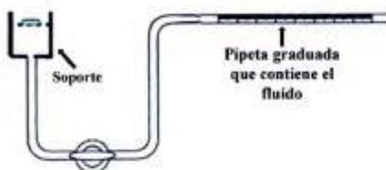
Figura 4.4. Esquema representativo del equipo utilizado para la medición de sorción de agua o soluciones.
