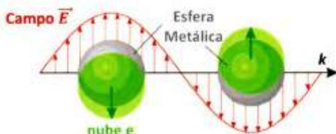
**Figura 1.1** Representación esquemática simplificada de la polarización inducida en una nanopartícula metálica por interacción con un campo eléctrico incidente que oscila en el tiempo. Los electrones de conducción de la nanopartícula metálica oscilan a una frecuencia característica de la nanoestructura debido al acoplamiento con el campo eléctrico. Esta oscilación colectiva de los electrones de la banda de conducción recibe el nombre de resonancia plasmónica localizada (LSPR).
