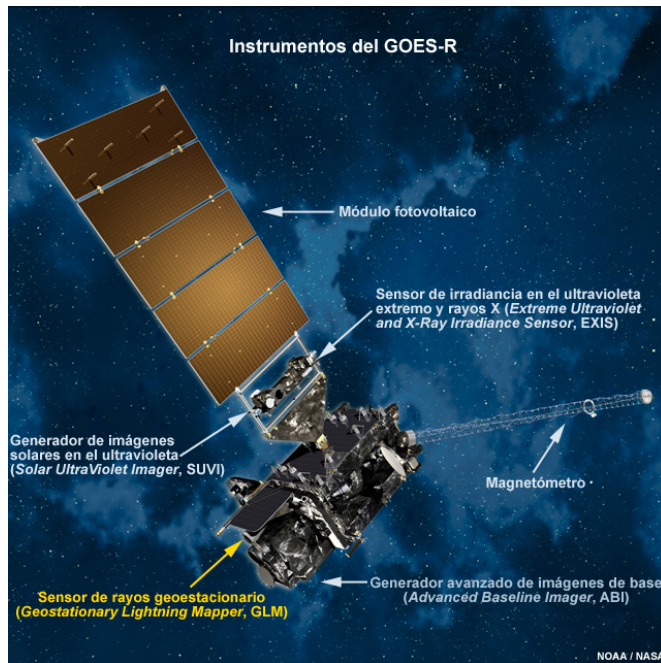
Figura 1.16: Satélite GOES-16 y sus instrumentos.
