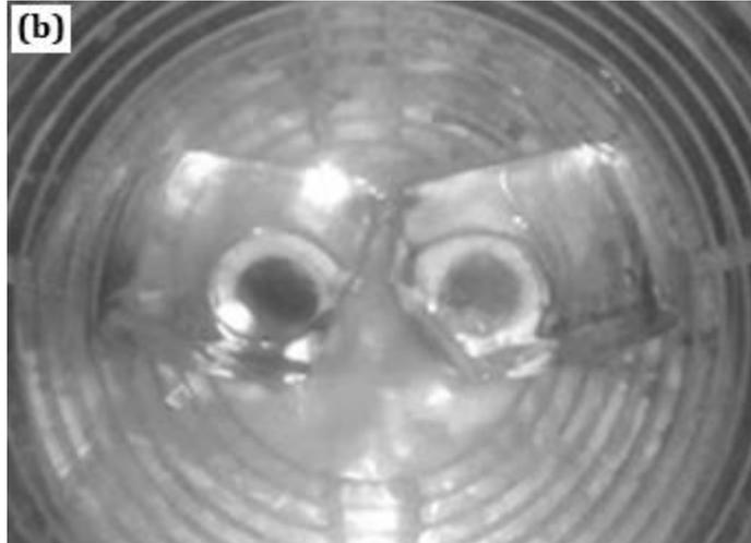
Figura 2.14. a) Esquema de sembrado de semillas cristalinas para un bicristal; y b) su respectiva fotografía. El monocristal inicial es cortado con calor de forma asimétrica y ambos cristales resultantes son rotados para tener la desorientación deseada.
