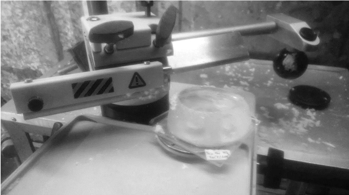
Figura 2.1. Desbaste y pulido de una muestra cristalina. El cristal de hielo se adhiere mediante calor a un portaobjetos de vidrio para su manipulación. A cada paso de la hoja del micrótopo la platina asciende un paso. El paso de ascenso de la platina es regulable y va desde los  $0\ \mu\text{m}$  a los  $30\ \mu\text{m}$ . El proceso se realiza dentro de una cámara frigorífica para preservar la muestra.
