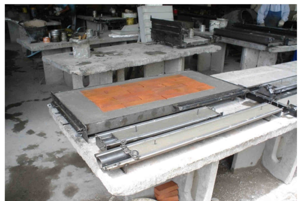
Figura 17 – Molde de molduras y respaldo.
