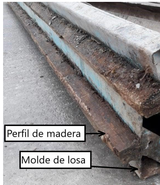
Figura 51: Moldes modificados para vincular losas de hormigón.
