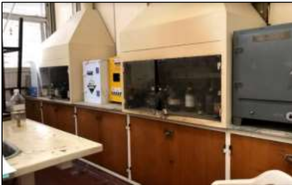
Fotografía 34. En uno de los costados del aula se disponen las siguientes dos campanas, en donde se almacenan ácidos peligrosos y drogas sólidas igual que en la parte de abajo de las 4 mesadas, todos con candados.
