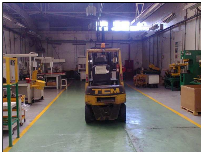
Resultado final del sector de S&R: Bancos de trabajo y armarios a la izquierda (incluye sector No Conforme) y línea de máquinas a la derecha. Calle central para ingreso y egreso de material bien delimitada a fin de evitar riesgos durante los movimientos a los operadores.
