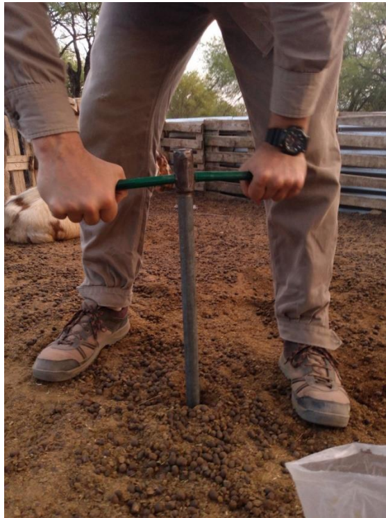
Imagen 1. Extracción de muestras de guano del corral con un sacabocado
