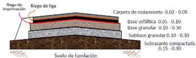
Figura 16 – Capas Pavimento Flexible. Fuente: Filminas de clase Transporte III
