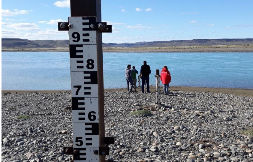
Figura 60.- Escalas de obra en el río Santa Cruz, sección La Barrancosa.
