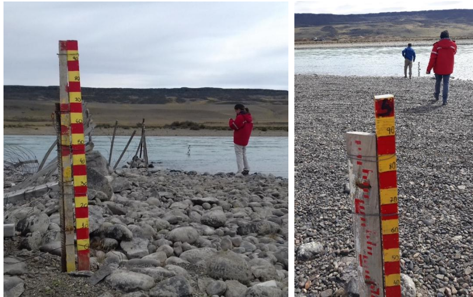
Figura 58.- Escalas de obra en el río Santa Cruz, sección Cónдор Cliff.
