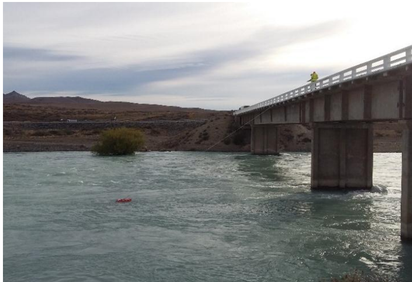
Figura 24.- Realización de aforo líquido desde puente utilizando el ADCP Teledyne RDI. Sección La Leona Norte.
