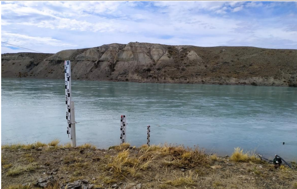
Figura 56.- Escalas de la Red Hidrometeorológica Nacional en el río Santa Cruz, sección Charles Fuhr, campaña 6.
