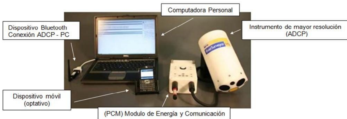
Figura 20.- Elementos necesarios para realizar mediciones con ADCP
