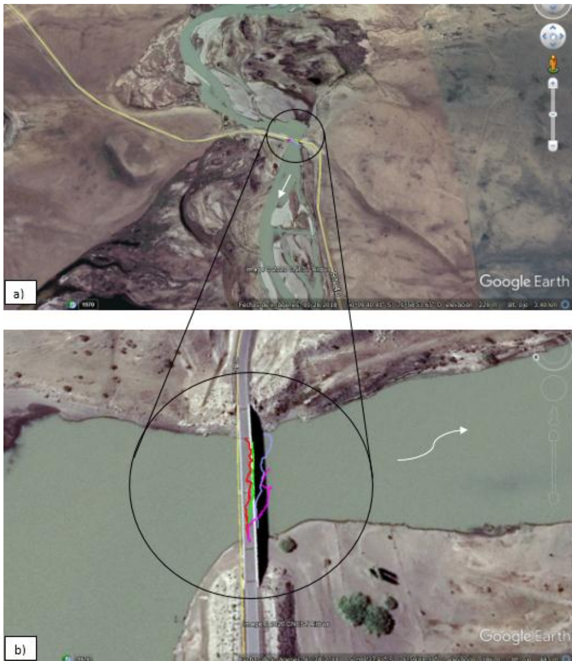
Figura 36.- Recorrido del ADCP, sección Leona Sur. a) Vista alejada. b) Zoom de la sección
