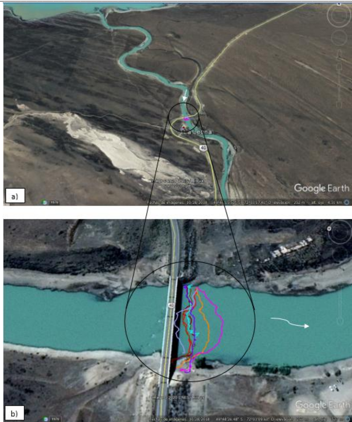
Figura 35.- Recorrido del ADCP, sección Leona Norte. a) Vista alejada. b) Zoom de la sección
