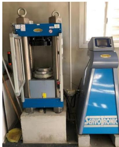
Figura 5.19. Prensa de ensayo de resistencia a la compresión
