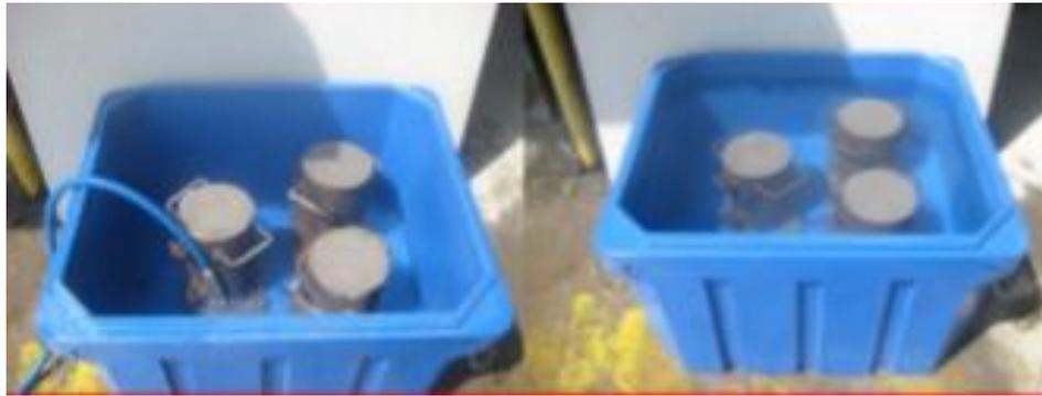
Figura 5.18. Bachas con probetas sumergidas en agua.
