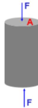
Figura 5.20. Principio físico del ensayo de compresión
