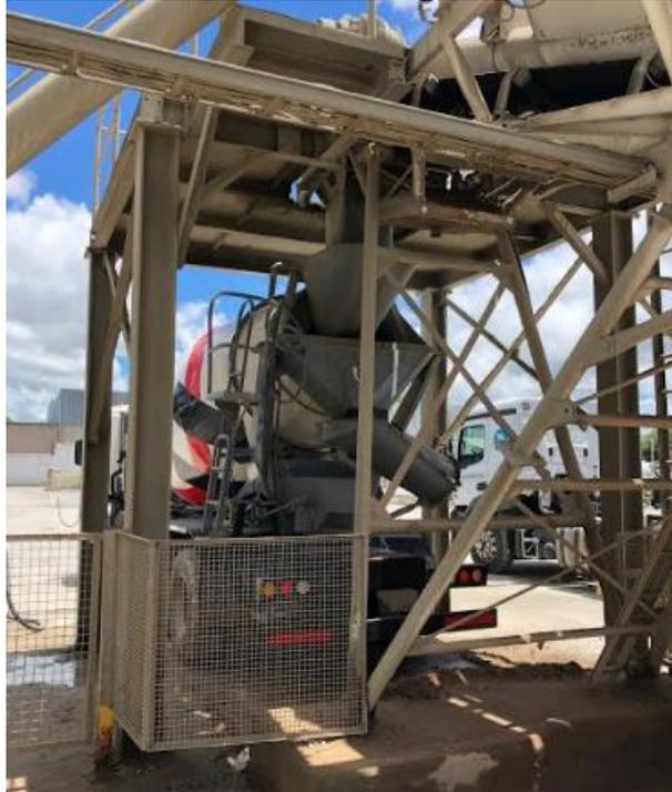
Figura 4.22. Camión Motor hormigonero siendo cargado
