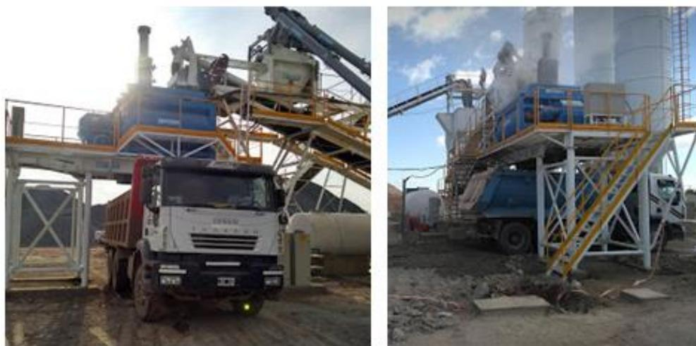
Figura 4.27. Carga de Hormigón en Camiones tipo Batea
