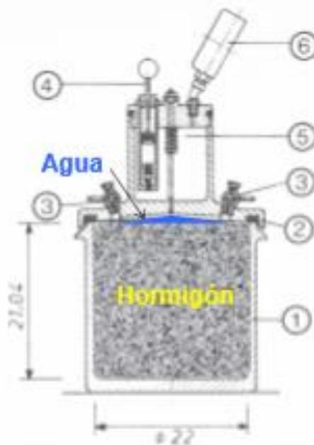
Figura 5.15. Paso a paso del ensayo de medición de aire
