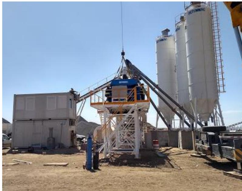
Figura 4.28. Silos de Almacenaje de Cemento
