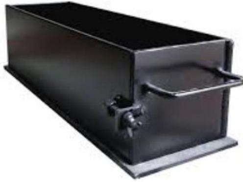
Figura 5.22. Probeta prismática para ensayo de resistencia a la flexión
