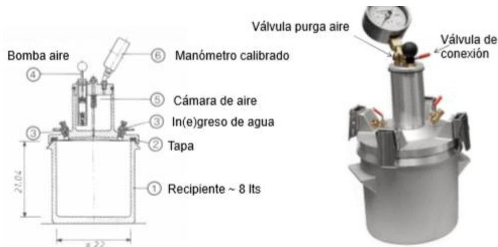
Figura 5.14. Equipo de medición de aire Washington
