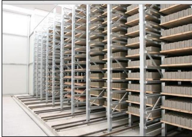
Fig. N° 6 Cámara de Curado Gentiliza-Compañía Quadra)
