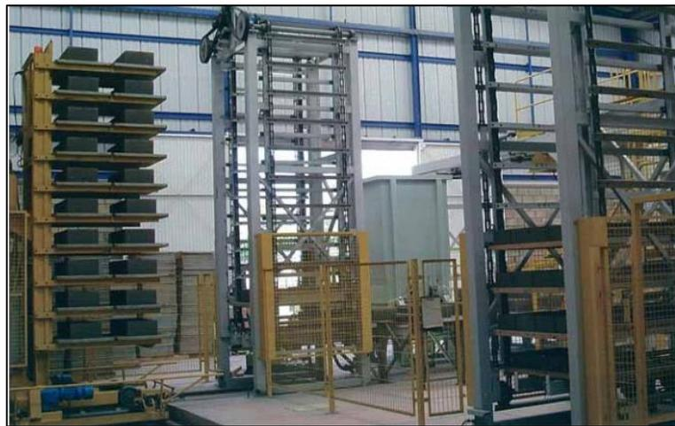
**Fig. N° 4** Estructura tipo RACK para el traslado de los Productos (Gentiliza-Compañía Poyatos)
