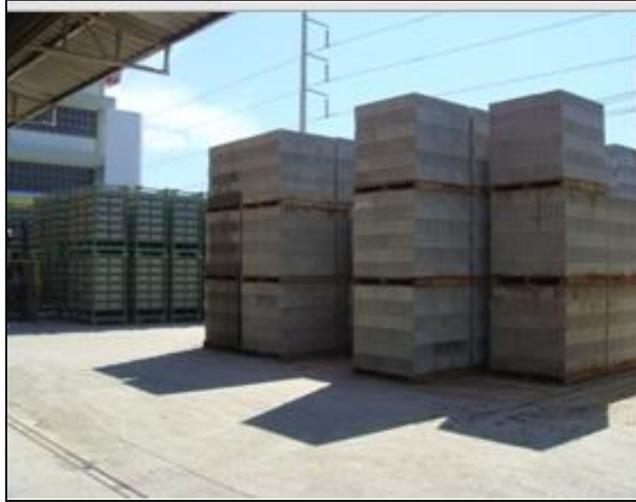
**Fig. N° 8** Almacenamiento de los Pallets con Bloques Terminados (Gentileza-Compañía Quadra)
