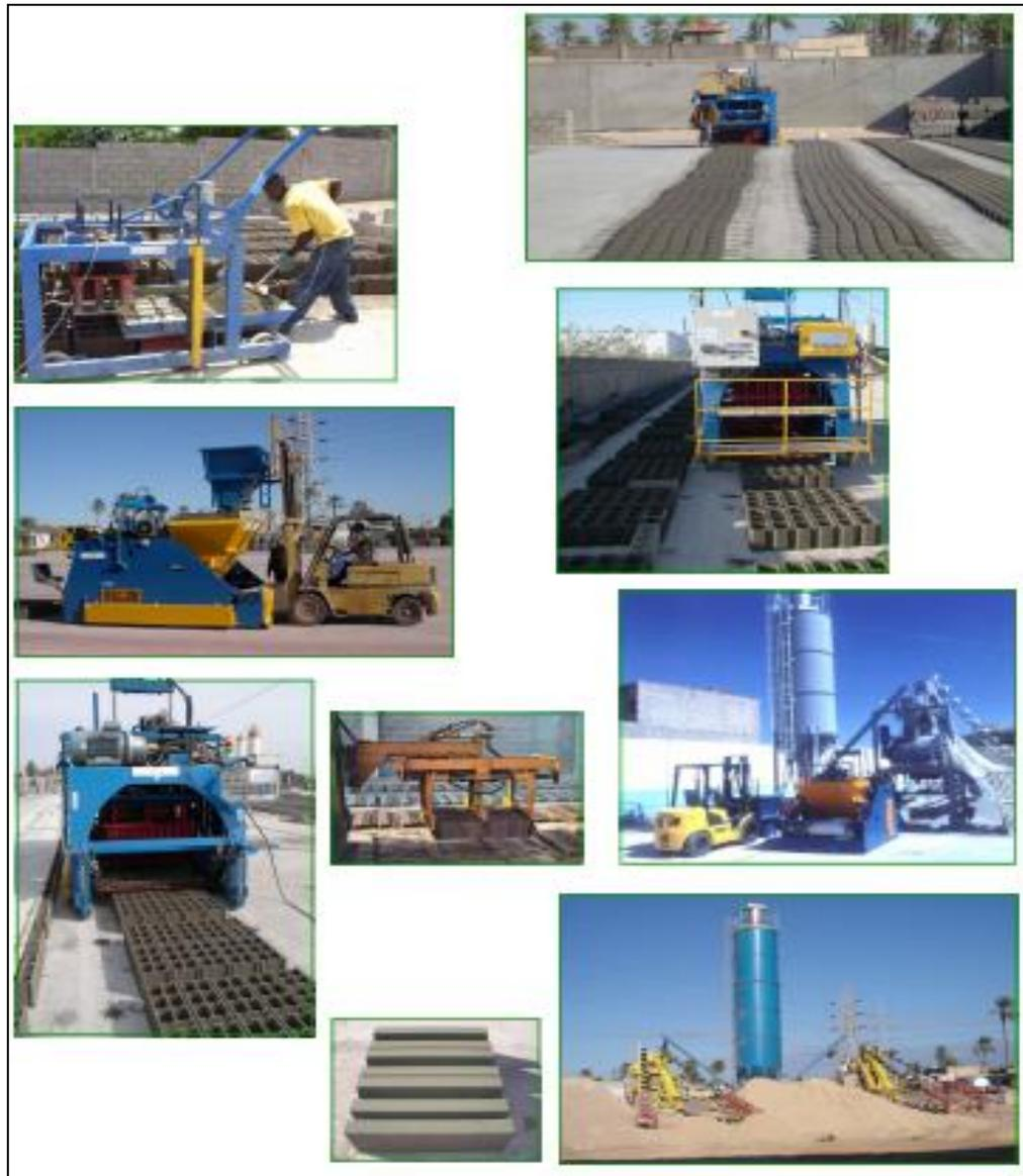
**Fig. N° 11** Ciclo productivo de una Máquina Ponedora (Gentileza-Compañía Rometa)
