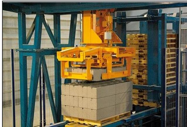
Fig. N° 7 Paletizadora-Cubadora de los Productos Terminados
