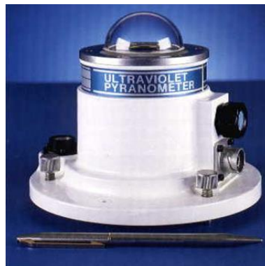
Figura 2.5. Radiómetro YES UVB-1, para medir irradiancia global UV-B de banda ancha (280 nm - 315 nm).
