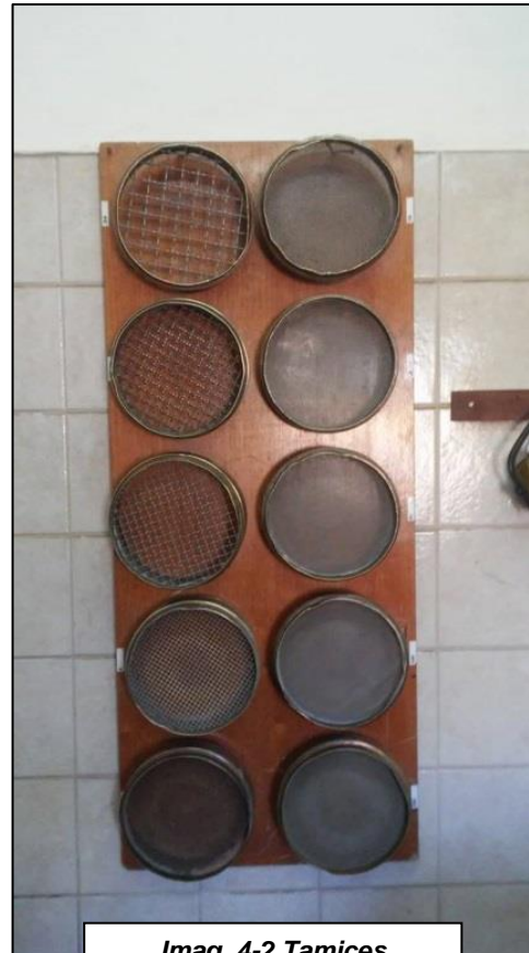
Imag. 4-2 Tamices utilizados para el ensayo de granulometría
