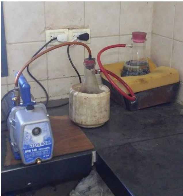
Imag. 4-7 Muestra conectada a bomba de vacío
