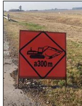
Imag. 2-29 Señal de Maquinas a 300 metros
