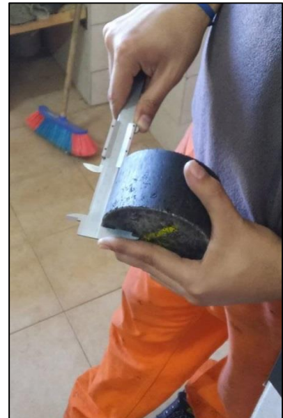
Imag. 4-5 Medición de la altura de las probetas
