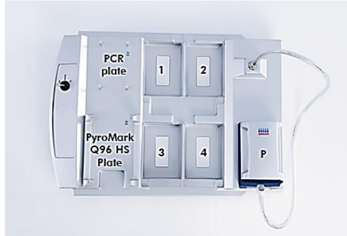
Figura 3.7: Estación de trabajo de vacío PyroMark Q96. Las posiciones marcadas contienen: (1) etanol al 70%, (2) solución desnaturalizante PyroMark, (3) tampón de lavado PyroMark y (4/P) agua ultrapura.
