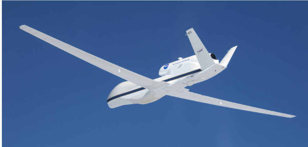
Figura 1-4: Northrop Grumman® Global Hawk, un UAV del tipo HALE utilizado por la NASA para misiones científicas.
