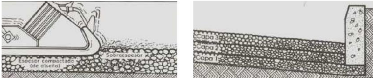
Figura 4.15: Compactación de las diferentes capas de la base
