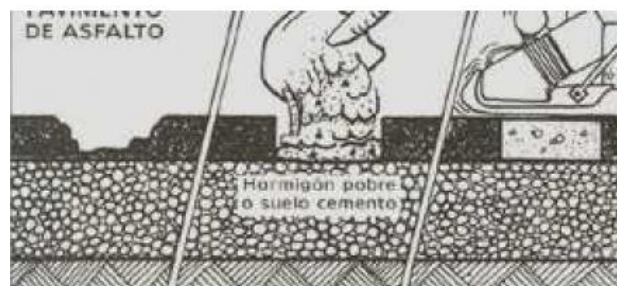
Figura 4.16: Rellenado de huecos de un pavimento de asfalto con hormigón pobre
